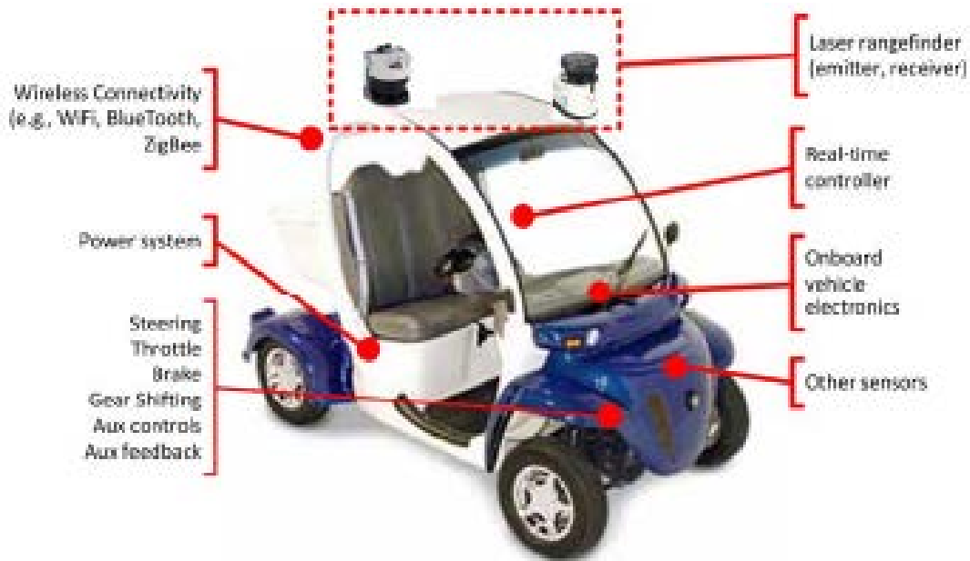
ნახ.2. უპილოტო სახმელეთო სატრანსპორტო საშუალება (UGV), რომელიც მოიცავს სენსორებს, მიკროპროცესორებს და საკომუნიკაციო მოწყობილობებს.
