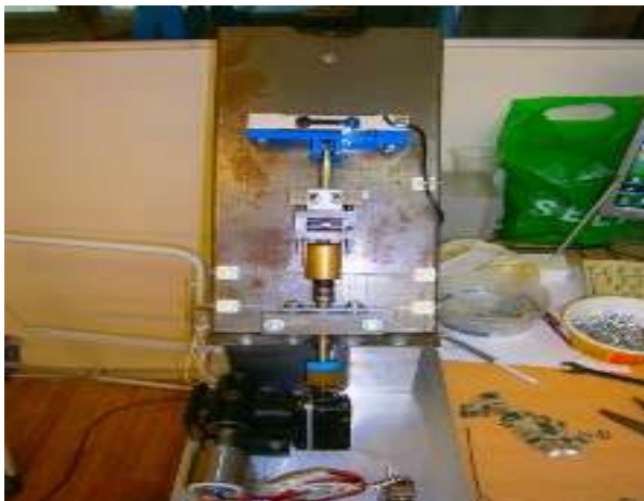
ნახ.8. სიმტკიცის შესამოწმებელი სტენდი
