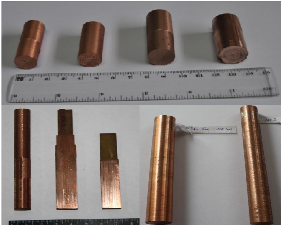
სურათი 1. 900C 0 -ზე მიღებული Cu-(5±40%)W კომპოზიტები მექანიკურად დამუშავების შემდეგ. წნევის ინტენსივობა 5გპა-მდე.
