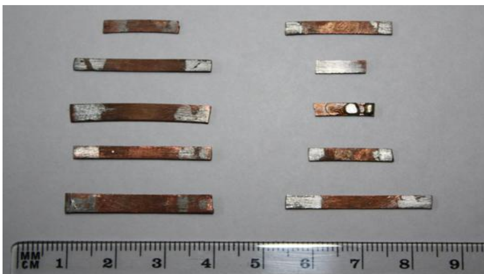
სურათი 5. მექანიკური და ელექტრული თვისებების შესასწავლად ფირფიტებად დაჭრილი W-Cu კომპოზიტები
