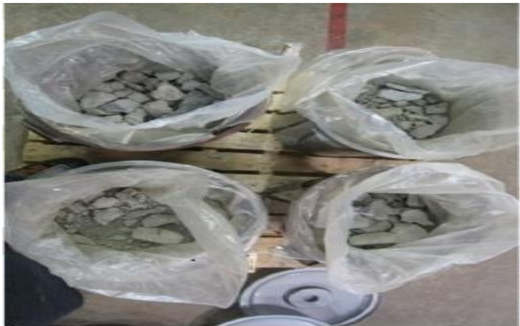
ნახ.5 ბალანსგარე მადნის წარმომადგენლობითი სინჯი, მინერალოგიურ ტექნოლოგიური შესწავლისათვის
