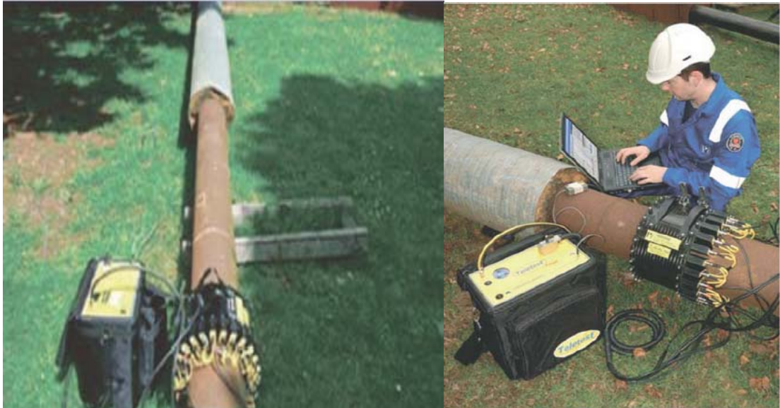
სურათი 2. FOCUS TELE TEST -მოწყობილობით მუშაობის პრინციპი
