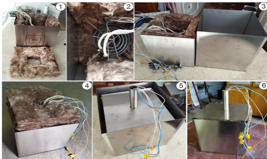
ნახ. 2. ექსპერიმენტული დანადგარის აწყობისა და კონსტრუქციული ელემენტების მომზადების ეტაპები
