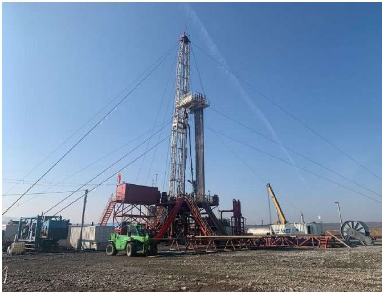
სურ. 1. დასავლეთ რუსთავის B1 ჭაბურღილის გასაბურღად გამოყენებული დანადგარი ZJ-40
