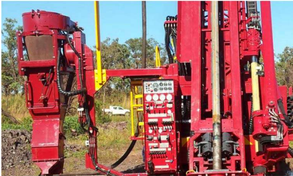
სურ. 2. ავტომატიზაციისა და კონტროლის სისტემებით აღჭურვილი თანამედროვე რევერსიული საბურღი დაზგა
