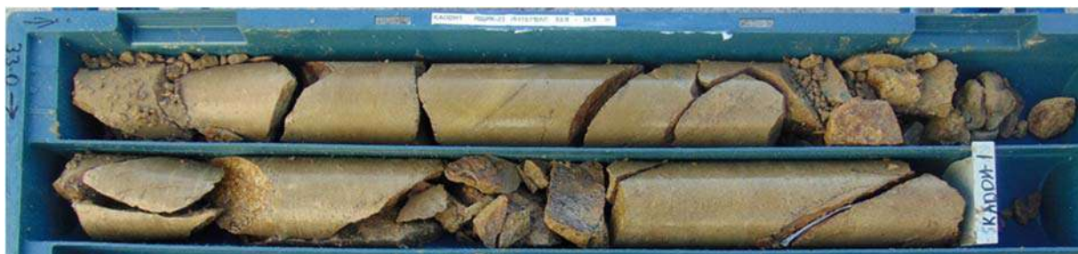
სურ 1. ფსამიტური რიოდაციტური შედგენილობის ტუფები (კაკლიანი, ჯაბურღილი KADDH1, ინტერვალი 33-34.5 მ)
