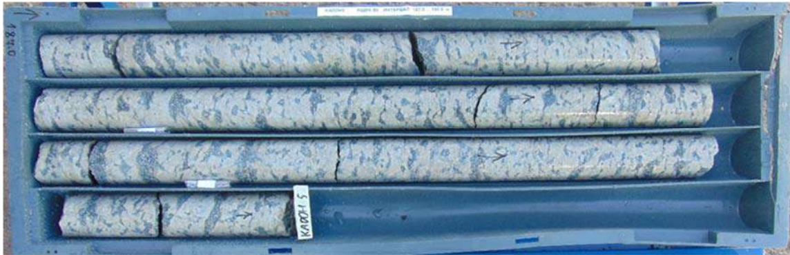
სურ. 4. მსხვილნატეხვანი, რიოდაციტური შედგენილობის, ღია მომწვანო ფერის, იგნიმბრიტისებრი, ლითო-ვიტროკლასტური ტუფები (კაკლიანი, ჭაბურღილი KADDH5, ინტერვალი 187-190 მ)
