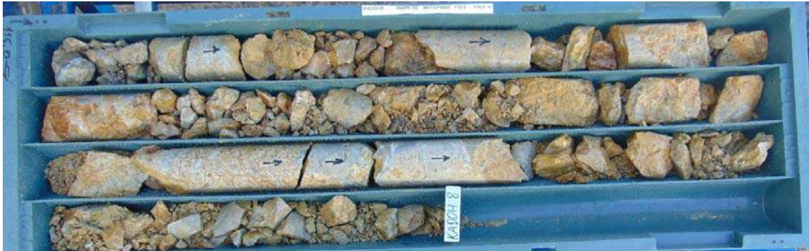
სურ. 6. დაჟანგული, რიოდაციტური შედგენილობის, მოყვითალო ფერის ტუფები (კაკლიანი, ჭაბურდელი KADDH8, ინტერვალი 115-118 მ)
