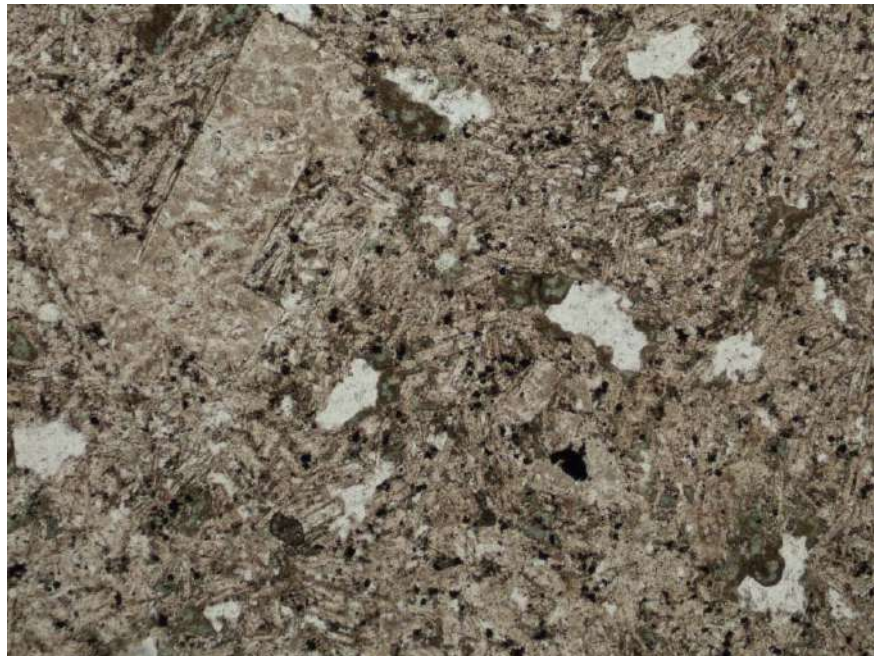
სურ. 5. ანდეზიტ-დაციტი, პლაგოიკლაზის (და რქატყუარის) პორფირული გამონაყოფებით და მიკროლიტებით ძირითად მასაში. ქანი ქლორიტიზებულია. პარალელური ნიკოლები, გადიდება 50-ჯერ
