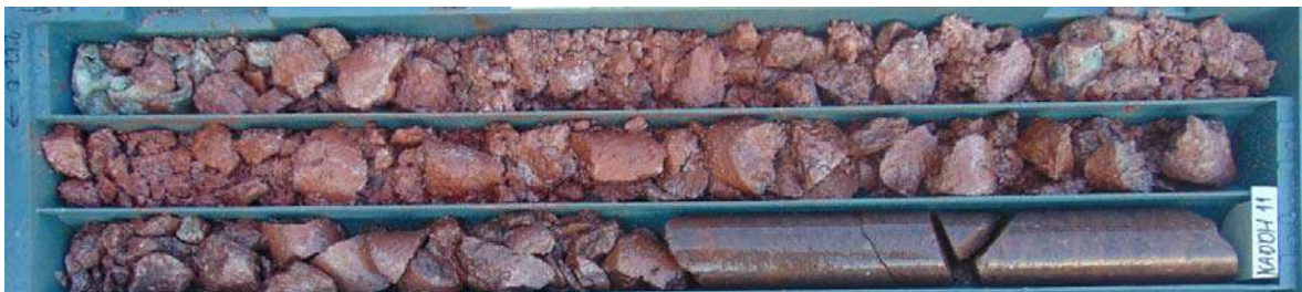
სურ. 7. დაჟანგულ-ლიმონიტიზებული, რიოდაციტური შედგენილობის, მოწითალო ფერის ტუფები (კაკლიანი, ჭაბურდელი KADDH11, ინტერვალი 222-225 მ)
