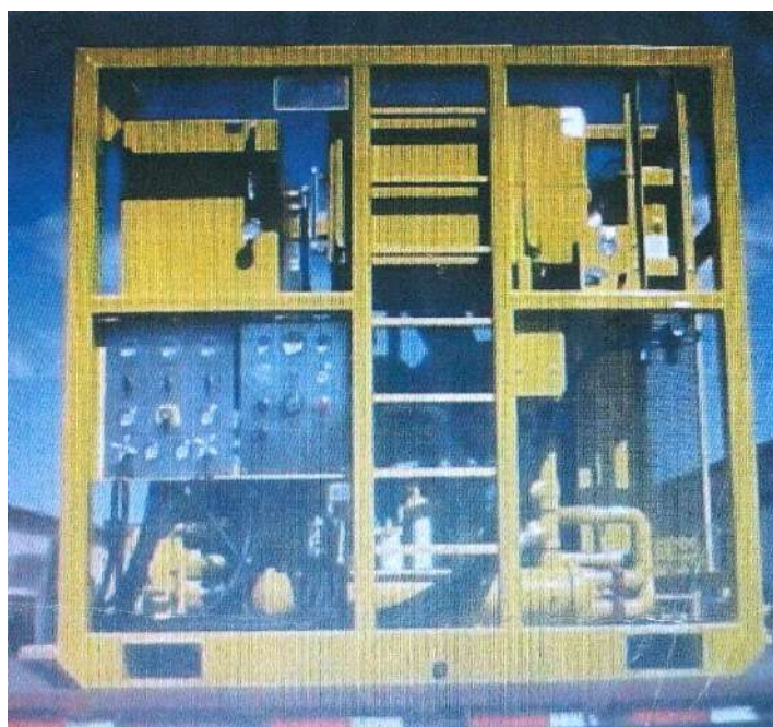
სურ. 5. კოლტუბინგური დანადგარით დახრილ-მიმართული და ჰორიზონტალური ბურღვისას ჭაბურღილების პირზე დაყენებული ამოსროლის საწინააღმდეგო მოწყობილობა
