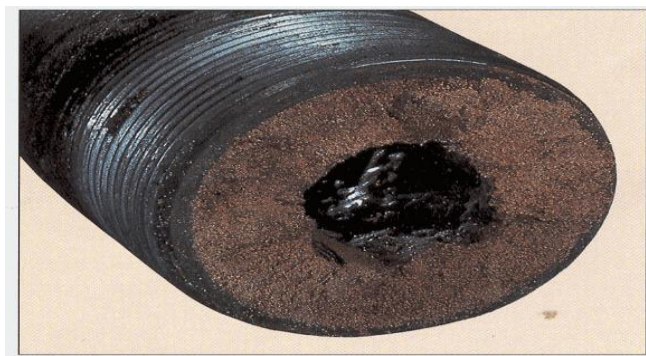
ნახ.1.1. სს მილში წარმოქმნილი ასფალტფისოვან პარაფინური ნადები
