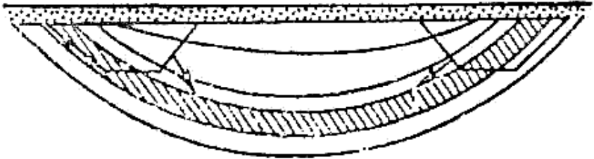
ნახ. 4.3. მულდისებრ განლაგებული ქანების დამუშავების თანმიმდევრობა
