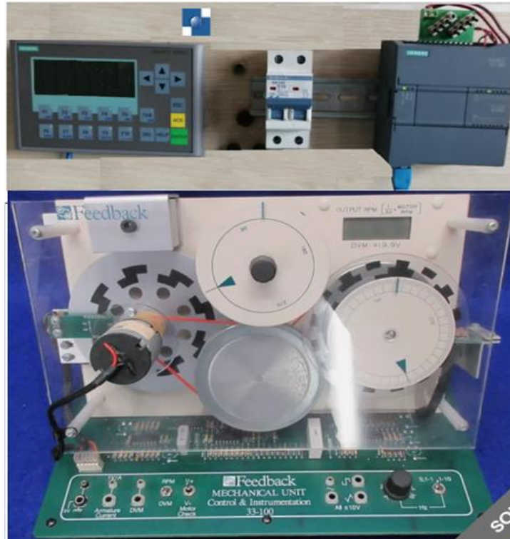
ნახ. 4. სერვისისტემის არამკაფიო ლოგიკური კონტროლერი S7-1200 პლკ-ს ბაზაზე
