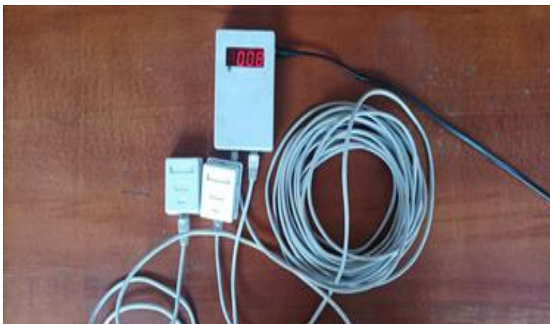
ნახ. 3 რეალიზებული და მომუშავე საზომის სისტემის ლაბორატორიული ნიმუშის ფოტო სენსორული ბლოკებითა და საკომუნიკაციო კაბელებით
