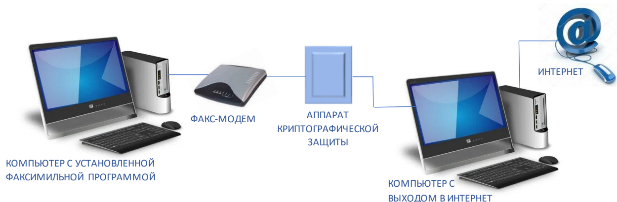
Рис.74. Структурная схема подключения аппарата криптографической защиты с факс-модемом под управлением компьютера
