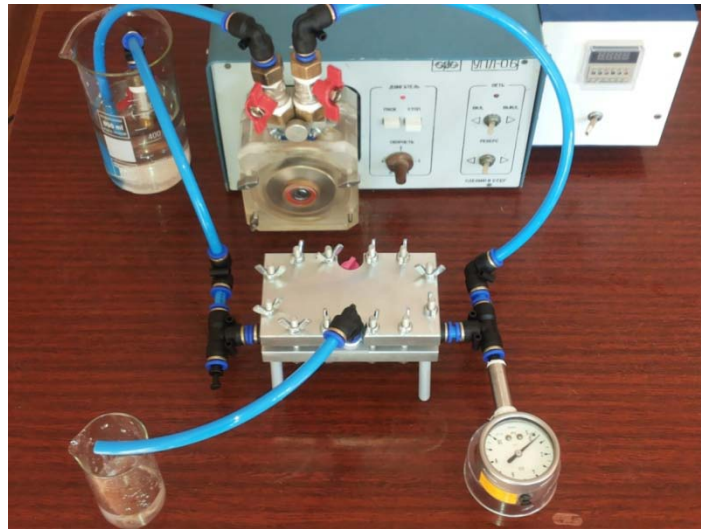
სურათი 2. მიკრო- და ულტრაფილტრაციული ლაბორატორიული მემბრანული დანადგარი
