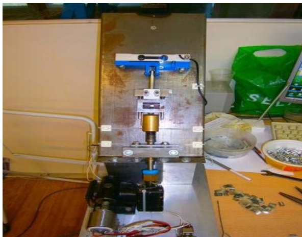
ნახ.8. სიმტკიცის შესამოწმებელი სტენდი
