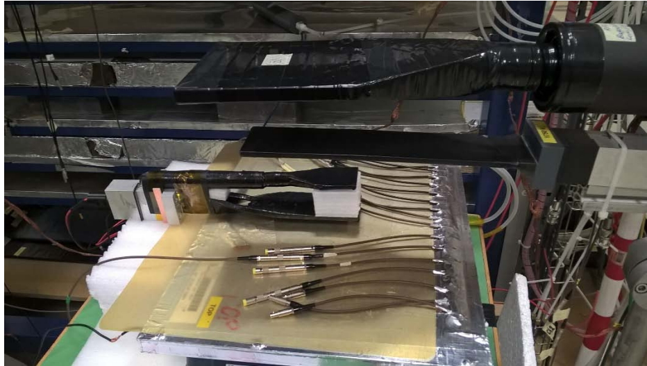
ნახ.1. 2 მთვლელიანი სცინტილაციური ტელესკოპები კოსმოსური მიონებისთვის.
