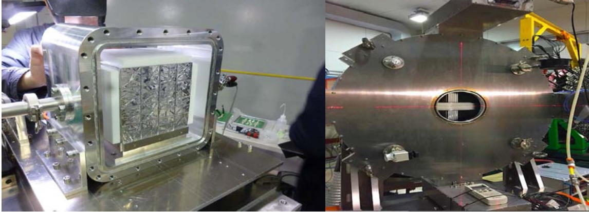
ნახ. 42. ელექტრომაგნიტური კალორიმეტრის (LYSO კრისტალების 8x8 მატრიცა, 64 კრისტალი). და სტროუ დეტექტორის პროტოტიპი.
