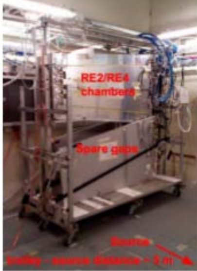
ნახ. 7. მარცხნივ ნაჩვენებია რადიაციული მედეგობის შესასწავლი დანადგარი. მარჯვენა გრაფიკზე ორი სხვადასხვა ტიპის კამერების მიერ „დაგროვილი რადიაცია“ კამერების მიერ დღემდე „დაგროვილი“ მუხტის ერთეულებში.
