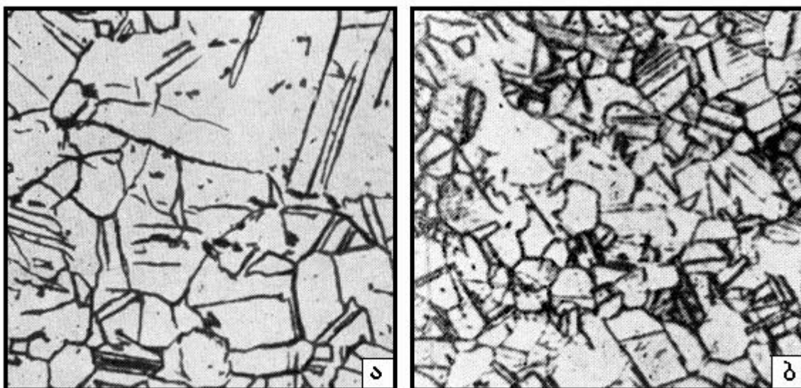
სურ. 24.1. სპილენძის მიკროსტრუქტურა ა – სხმულ და მომწვარ მდგომარეობაში, x200 ბ – დეფორმირებულ და მომწვარ მდგომარეობაში, x100
