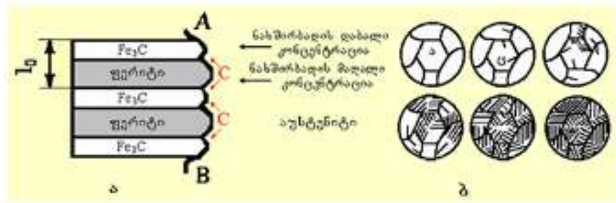
სურ. 6.8. ნახშირბადის გადანაწილების (ა) და პერლიტის წარმოქმნის სქემა (ბ) ევტექტოიდური გარდაქმნის დროს
