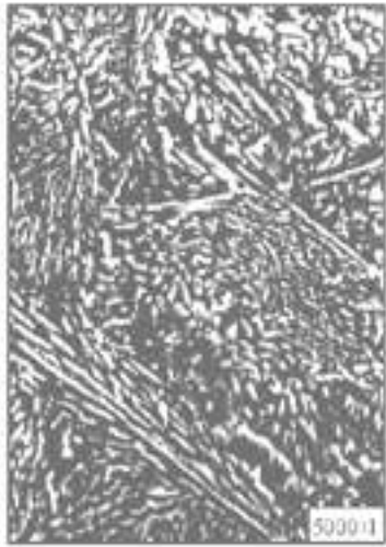
სურ. 6.14. ზედა ბენიტური სტრუქტურა
