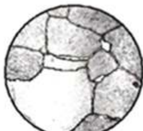
სურ. 53. ტექნიკური რკინის მიკროსტრუქტურა. x 400 ა- C < 0,01\% , ფერიტი; ბ- C = 0,01-0,02\% , ფერიტი და Fe_3C_{III} (თეთრი უბნები მარცვლის საზღვრებში)
