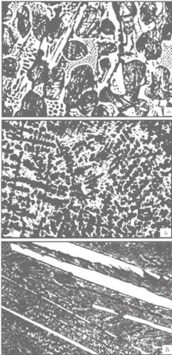
სურ. 5.6. თეთრი თუჯის მიკროსტრუქტურა. x200. ა-ქვევტემპტიკური; ბ-ვტემპტიკური; გ-ზევტემპტიკური
