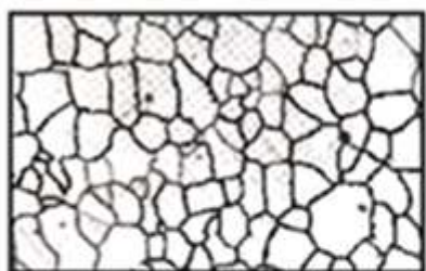
სურ. 53. ტექნიკური რკინის მიკროსტრუქტურა. x 400 ა- C < 0,01\% , ფერიტი; ბ- C = 0,01-0,02\% , ფერიტი და Fe_3C_{III} (თეთრი უბნები მარცვლის საზღვრებში)
