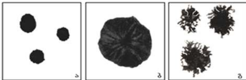
სურ. 5.9. გრაფიტის ჩანართის ფორმა მაღალი სიმტკიცის (ა, ბ, x200) და ჭედად (გ) თუჯებში
