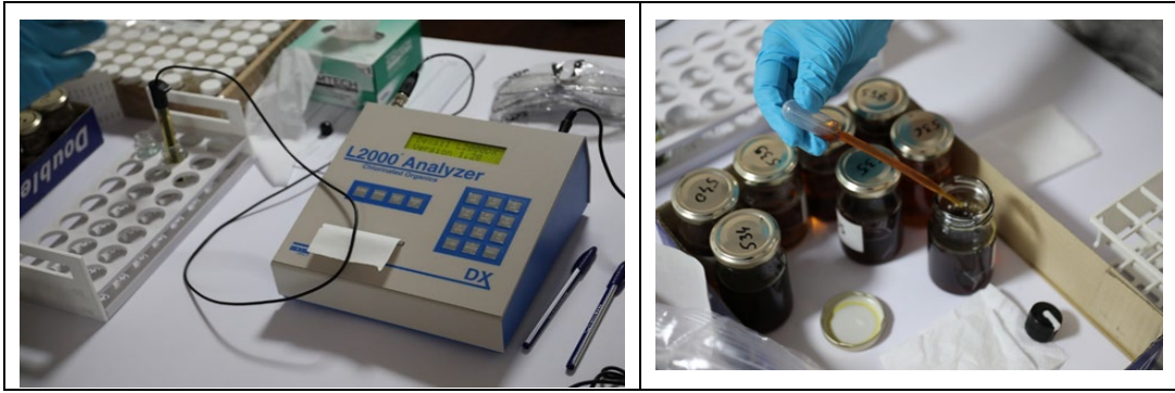
სურათი 5. ქლორ-სპეციფიკური ანალიზატორი (L2000DX) (მარცხნივ); დიელექტრიკული ზეთის სინჯები (მარჯვნივ)
