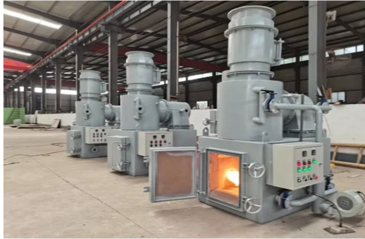
სურ. 2. სამედიცინო კლინიკის ფარმაცევტული ნარჩენის წვის უკვამლო ღუმელი WANROOETECH
