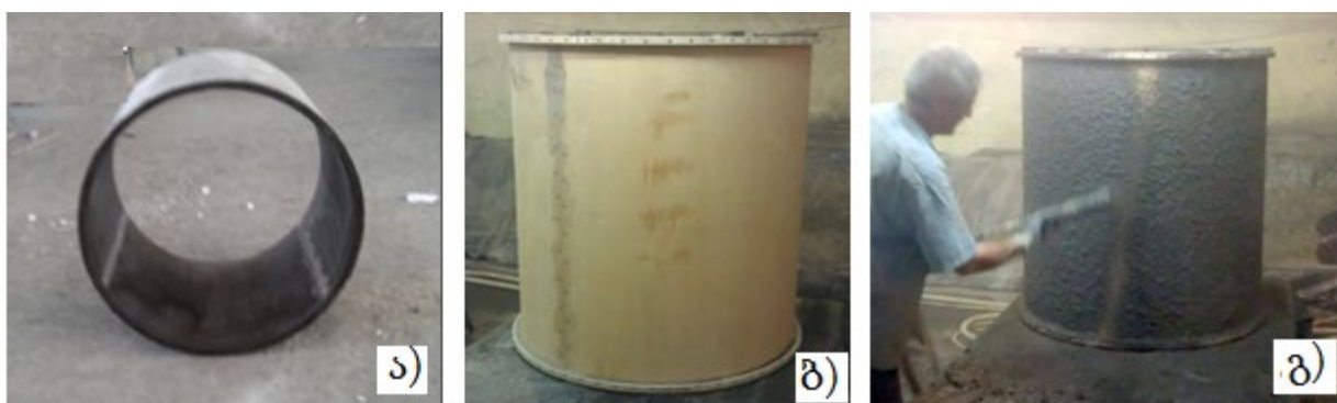
ნახ. 8. ფიბრობეტონის მილი (ა), ყალიბი (ბ) და მასის დატანა (გ)
