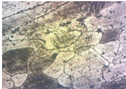
სურ.8. ფოლადი 08X25Г15C შენადული ნაკერის თერმული გავლენის ზონის მიკროსტრუქტურა. : X 800, HV – 174
