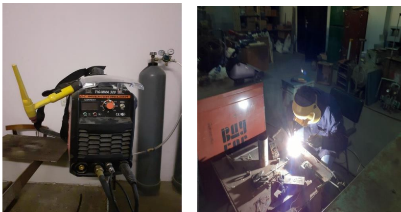
სურ. 2. ა. ინვენტორული არგონრკალური შედუღების აპარატი TIG/MMA 320 ბ. არგონრკალური დადუღების პროცესი BДУ-506-ზე.
