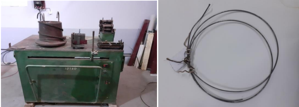
სურ. 1.ა. ფხვნილგულა მავთულის დასამზადებელი დანადგარი; ბ. ფხვნილგულა მავთული
