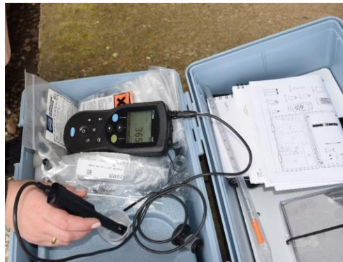
სურათი 2. მობილური ქიმიური ლაბორატორია (CEL Advanced Drinking Water Laboratory) ცხრილი №1. ჭისწყლების სინჯებში ქიმიური ნავთიერებების შემცველობა
