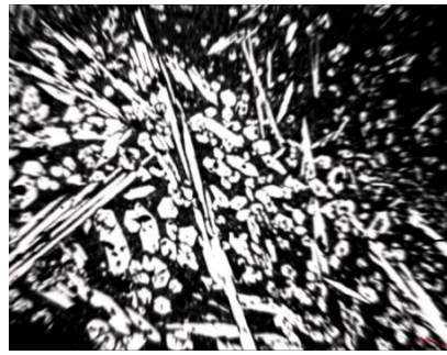
სურ. 4. ერთშრიანი დადუღებული ზედაპირის მიკროსტრუქტურა X 200 (49÷48,5) HRC საშუალო არის 48,7 HRC - ა, ბ., გ. და დ. უბნები. ორშრიანი დადუღებული ნიმუშის მიკროსტრუქტურა მოცემულია სურ.5-ზე.
