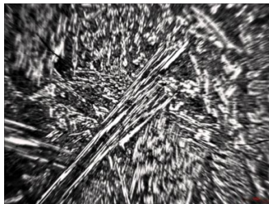
სურ. 5. ორშრიანი დადუღებული ნიმუშის მიკროსტრუქტურა X 100 (44,5-45,0-44,0) HRC საშუალო არის 44,5 HRC - ა, ბ., გ., დ. და ე. უბნები (x50).
