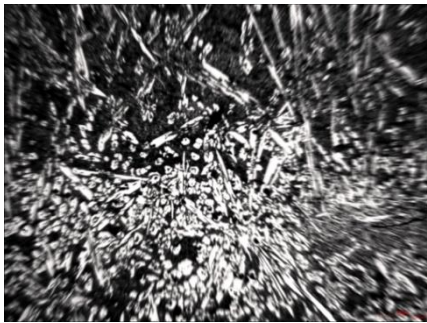
სურ. 4. ერთშრიანი დადუღებული ზედაპირის მიკროსტრუქტურა X 200 (49÷48,5) HRC საშუალო არის 48,7 HRC - ა, ბ., გ. და დ. უბნები. ორშრიანი დადუღებული ნიმუშის მიკროსტრუქტურა მოცემულია სურ.5-ზე.
