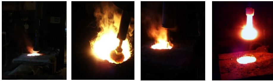
სურათი 1. თუჯის მოდიფიცირების ნატურული ტექნოლოგიური პროცესი
