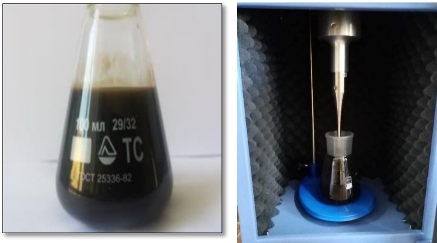
სურათი 9. გრაფენის ოქსიდის სუსპენზია (a) და მისი დამუშავება ულტრაბგერით ჰომოგენიზატორში (b)
