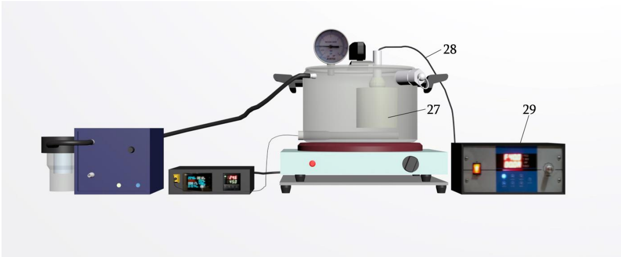
სურათი 9. ულტრაბგერის გენერატორით აღჭურვილი ტომატის წვენის კონცენტრირების ნაწილი
