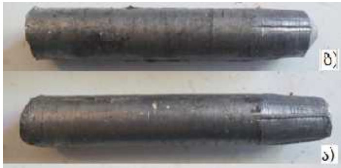
ნახ.4. დეფორმირებული ნიმუშები: ა - D20; ბ - D24 y = 115,02 + 41,21x_1 + 43,96x_2 - 28,84x_3 + 15,26x_1x_2 - 17,49x_2x_3 - 11,36x_1x_3 - 7,20x_1x_2x_3,
