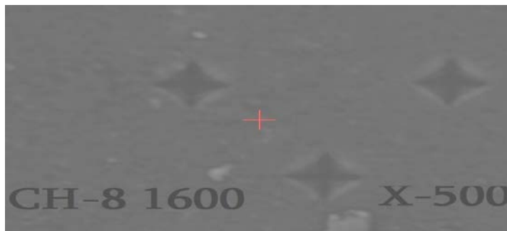
ნახ. 23. Si-Al-O-N მატრიცაში აღებული ანაბეჭდი
