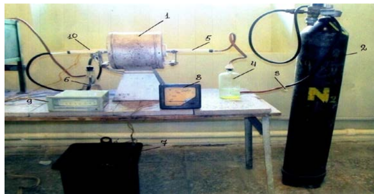
ნახ. 1. ნიტროალუმინოთერმული პროცესებით ნიმუშების გამოსაწვავი დანადგარი
