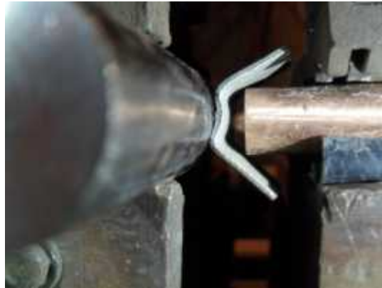
სურ. 2. სსსტც „დელტა“-ს მიერ წარმოდგენილი ერთერთი შესადული ნიმუშის АСИФ - 25 ტიპის მანქანაზე პირაპირა შედუღების ფოტო
