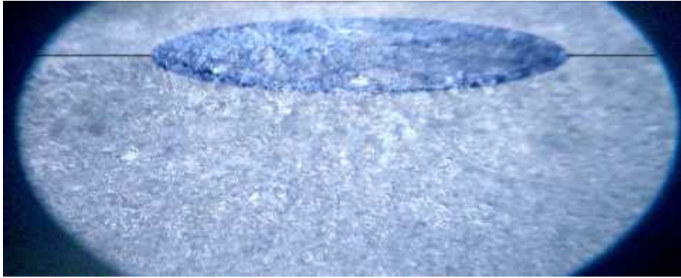
სურ. 4. სხვადასხვა სისქის ნიმუშთა კონტაქტური შედუღების დროს მიღებული სიმეტრიული წერტილი მასალა – უჟანგავი ფოლადი სისქეები – u_1= 3\text{მმ} ; u_2= 7\text{მმ}
