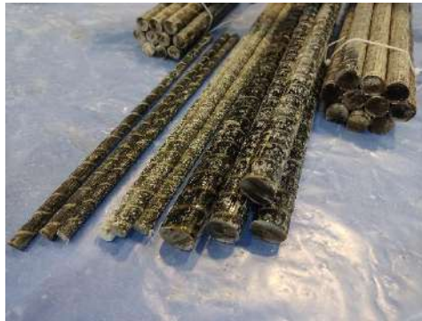
სურ. 1. ქართული ბაზალტკომპოზიტური არმატურა
