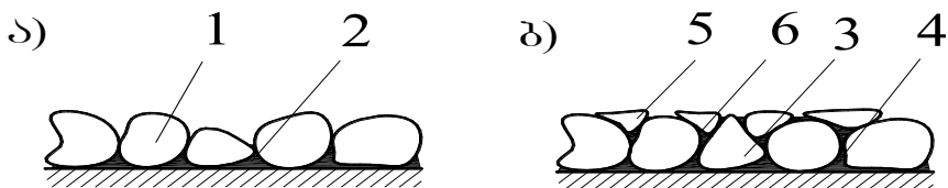
ნახ.2. ზედაპირული დამუშავების ფენის სტრუქტურა, სადაც: ა) ერთმაგი ზედაპირული დამუშავების ფენა. ბ) ორმაგი ზედაპირული დამუშავების ფენა. 1-ღორღი (აგრეგატი); 2-ბიტუმი; 3-მსხვილი ღორღი; 4-პირველადი მოსხმის ბიტუმი; 5-შედარებით უფრო წვრილმარცვლოვანი ღორღი; 6-მეორადი მოსხმის ბიტუმი.
