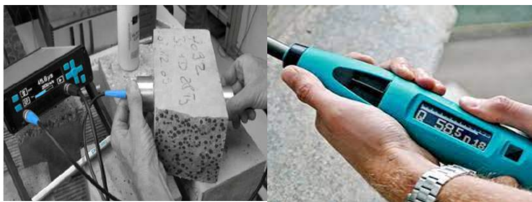
სურ.2 ბეტონის სიმტკიცის განსაზღვრა ურღვევი მეთოდით (1. დარტყმით-ომპულსური მეთოდი 2. ულტრაბგერითი მეთოდი)
