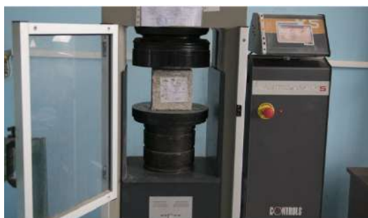
სურ.1 ბეტონის სიმტკიცის განსაზღვრა კუმშვაზე მრღვევი მეთოდით (ბეტონის კუბი კვეთით 15X15X15)
