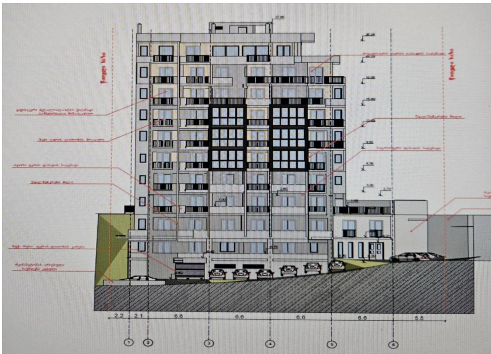
სურათი 3.22. მრავალბინიანი საცხოვრებელი სახლის ფასადი “1-6”. -9.50 ნიშნულის ქვეშ ტერიტორიაზე შესაღების საყრდენი კედელი. +18.95 ნიშნულზე “3” ღერძთან კაპიტალური მოაჯირის მოაჯირის ნაცვლად მოწყობილია ლითონის მოაჯირი. -9.50 და -6.50 ნიშნულებზე შეცვლილია კარების ნახატები. +22.10 ნიშნულზე შეცვლილია ფასადის ღებვის ფერი, დამატებით მოწყობილია რიგელები.
