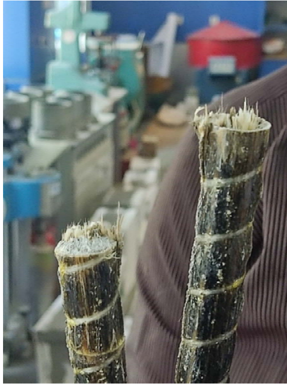
სურათი 3 ჭრაზე გამოცდილი ბაზალტკომპოზიტიური არმატურები
