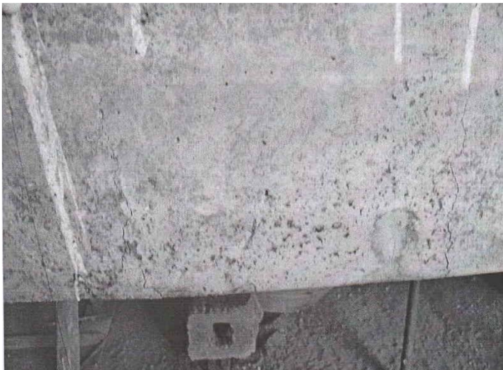
სურათი 11 ბაზალტით დაარმირებული კოჭის გამოცდის პროცესი
