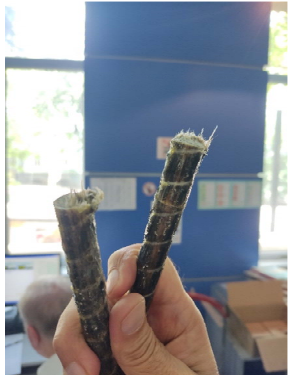
სურათი 2 ჭრაზე გამოცდილი ბაზალტკომპოზიტური არმატურები
