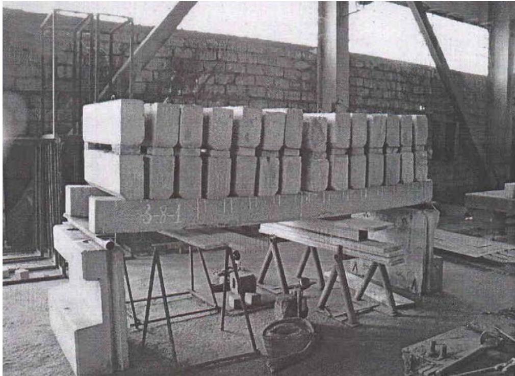
სურათი 8 ბაზალტით დაარმირებული კოჭის გამოცდის პროცესი
