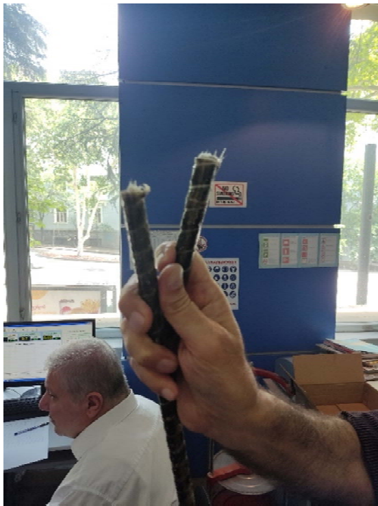
სურათი 2 ჭრაზე გამოცდილი ბაზალტკომპოზიტური არმატურები
