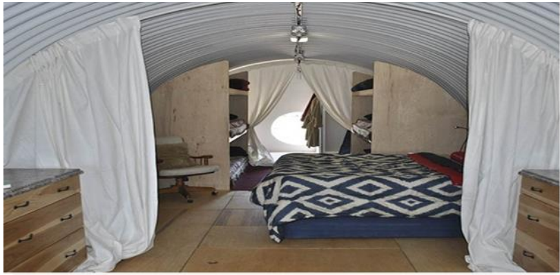
სურათი 1. ფოლადის შვეიცარიული თავშესაფარი (200PSI) კოდით, გათვლილია 10 ადამიანისთვის
