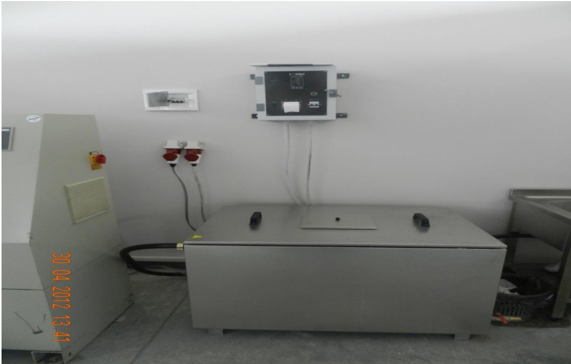
სურ. №7. ბეტონის ნიმუშების გასაორთქლი კამერა.
