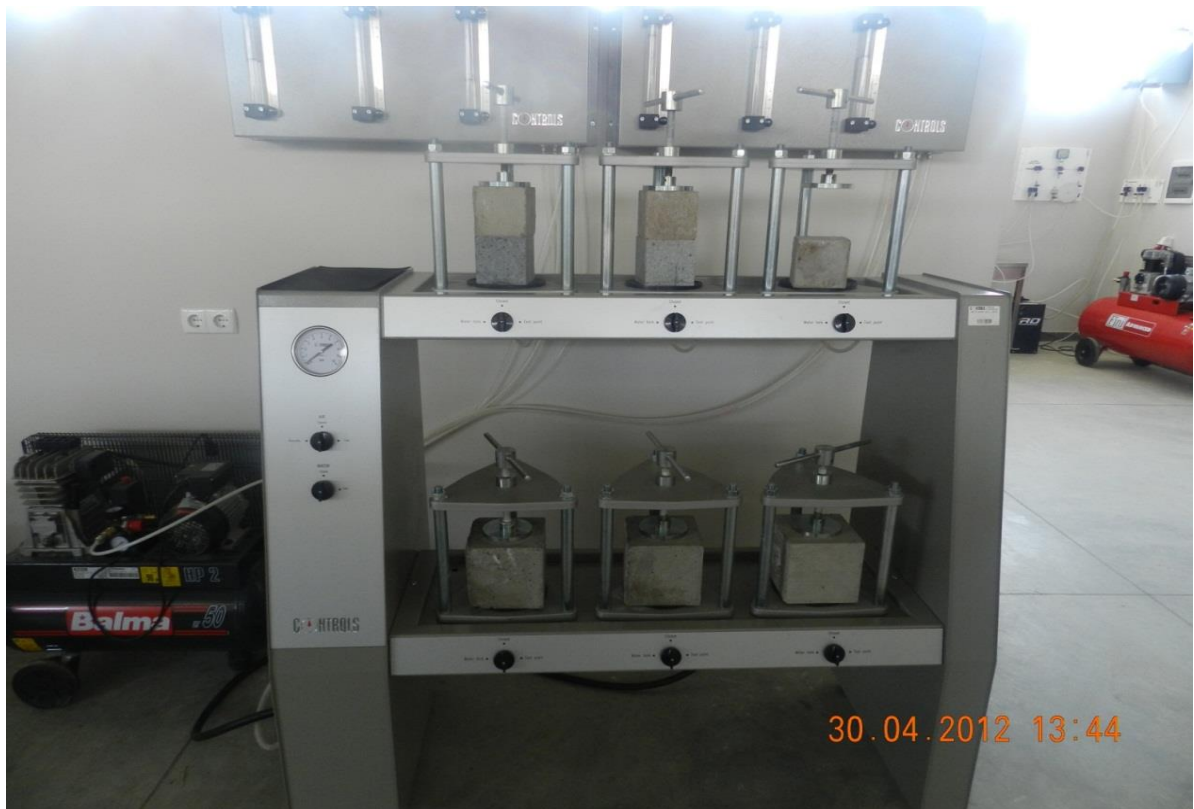
სურ. №9 ბეტონის ნიმუშების წყალშეუღწევადობის განმსაზღვრელი დანადგარი
