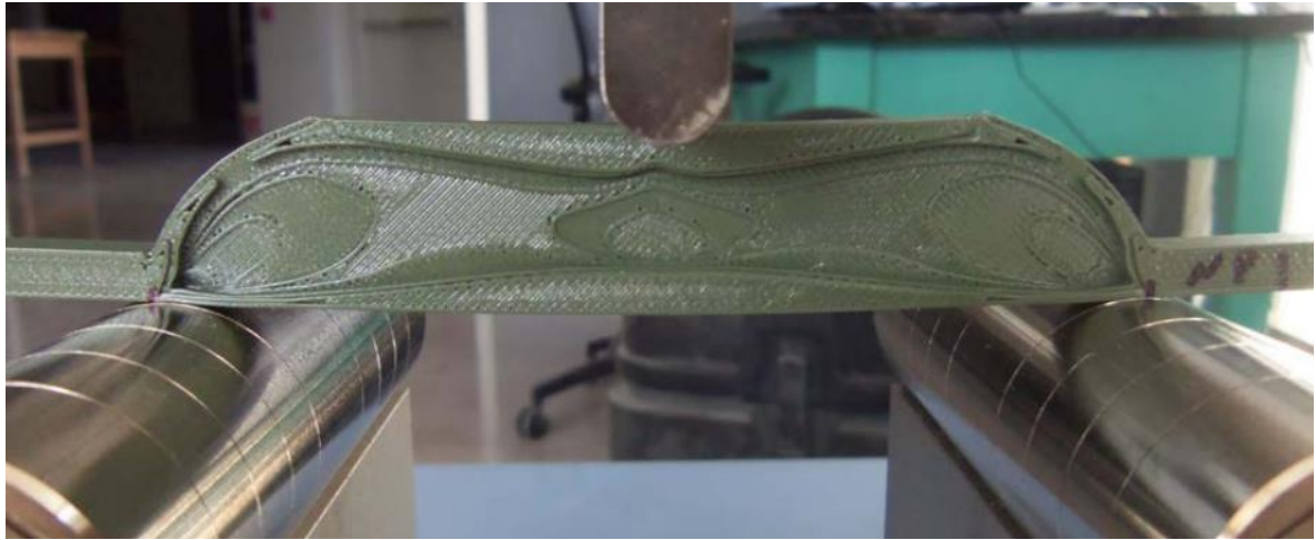
სურათი 46. MATLAB არა-პენალტიზირებული ძელის გამოცდა
