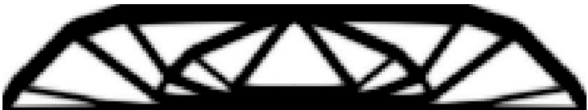
სურათი 33. შედეგად მიღებული ოპტიმიზებული სხივი MATLAB-დან პენალიზაციის კოეფიციენტით 3.0, ზომით 100x35 ელემენტი და რადიუსი 1.5 [მმ]
