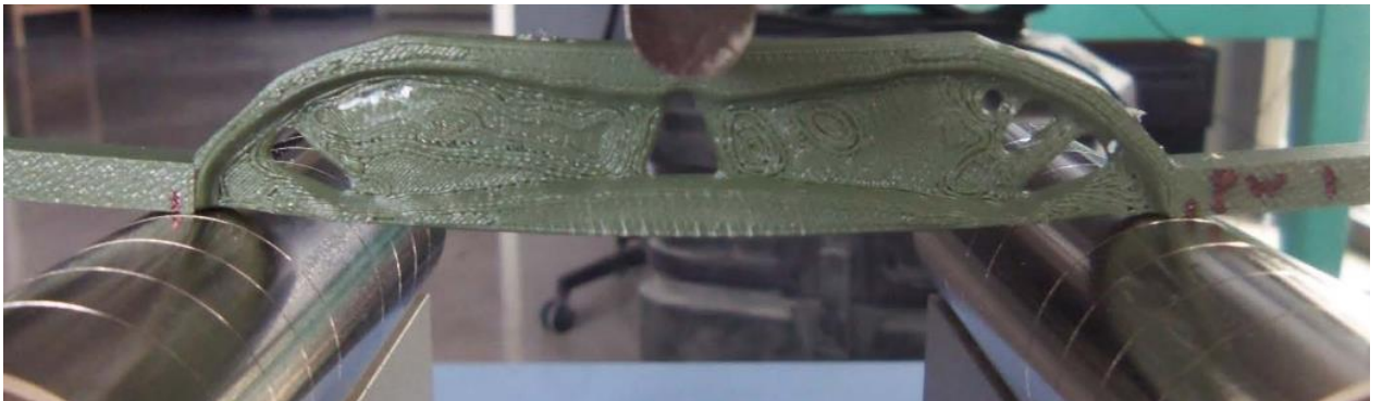
სურათი 49. ParetoCloud ის მიერ ოპტიმიზირებული ძელის გამოცდა
