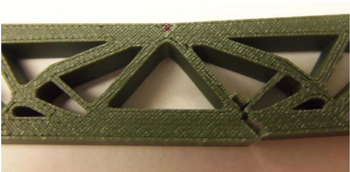
სურათი 44. MATLAB პენალტიზაციით ოპტიმიზირებული ძელის რღვევა
