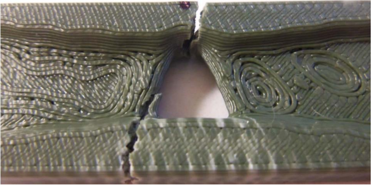
სურათი 50. ParetoCloud ის მიერ ოპტიმიზირებული ძელოსრდვევა
