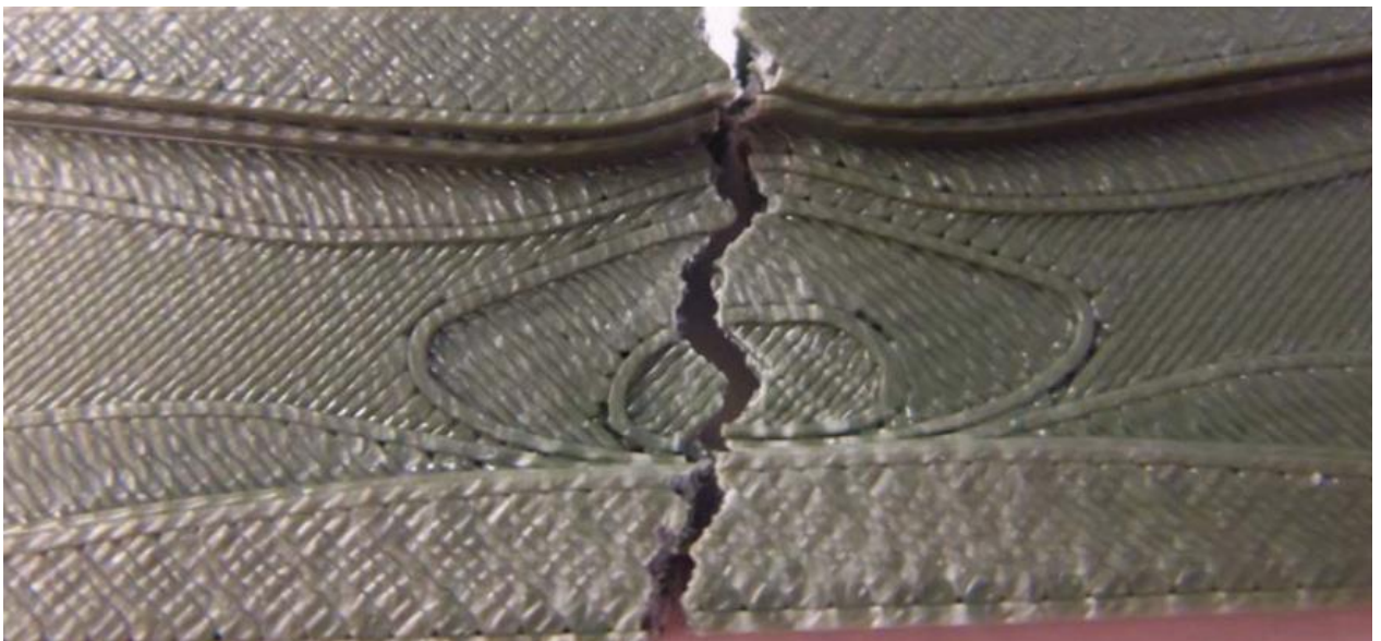
სურათი 47. MATLAB არა-პენალტიზირებული ძელის რღვევა
