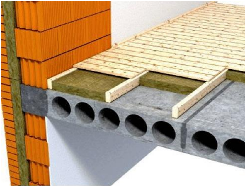
სურათი 8. რკინაბეტონის გადახურვის მონტაჟის სქემა საცხოვრებელ კორპუსში.
