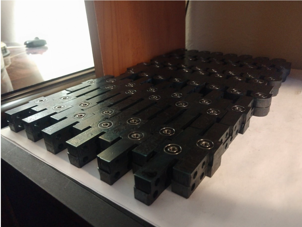
ნახ. 3.17 პანტოგრაფის შემადგენელი კომპონენტები მოქლონებით შეერთებამდე
