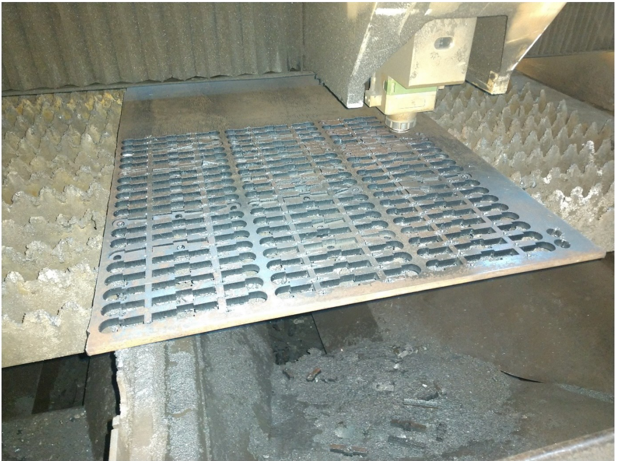
ნახ. 3.13 კვანძი 01, 02 და 03 ის მისაღებად საჭრელ მაგიდაზე განთავსებული ფოლადის ფურცლოვანა
