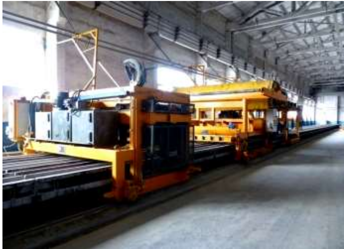
სურ. 5. დანადგარი, რომელიც უზრუნველყოფს სპეციალური ტილოს გადაფარებას კასეტურ ფორმებზე ორთქლის მიწოდებამდე
