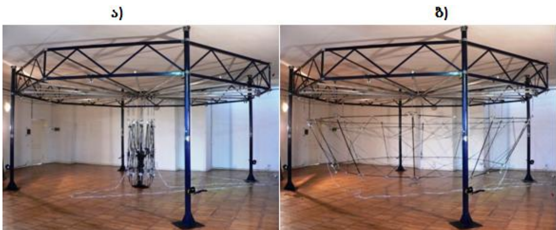
ნახ. 40 წაკვეთილი პირამიდის ფორმის მქონე „ჩასატეხ“ ღეროებიანი, ელექტრომექანიკური სისტემით გაშლადი, მოქნილი, გაჭიმულ ცენტრიანი რეფლექტორის გაშლის ეტაპების ფოტოკადრები
