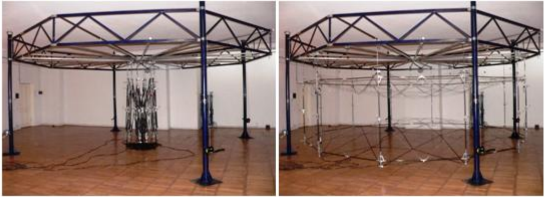
ნახ. 42 ვანტურ-ღეროვანი გასაშლელ რგოლიანი, მოქნილი დაჭიმულ ცენტრიანი გასაშლელი კოსმოსური რეფლექტორის ექსპერიმენტული ვარიანტი
