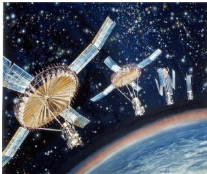
ნახ. 45 დიდი რეფლექტორის ბაზაზე აგებული თანამგზავრული კომპლექსი
