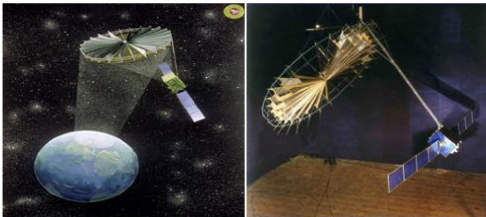
ნახ. 36 ოფსეტური დიდი გასაშლელი რეფლექტორული ანტენების ბაზაზე აგებული კოსმოსური კომპლექსი
