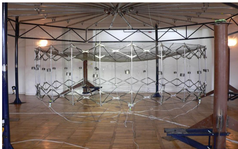
ნახ. 38 ორ რიგად განთავსებული პანტოგრაფული სტრუქტურის გამშლელ რგოლიანი და მოქნილი, გაჭიმულ ცენტრიანი გასაშლელი რეფლექტორის 4 მეტრი დიამეტრის ფუნქციონალური მოდელის ტრანსფორმაციები დაკეცილი მდგომარეობიდან მისი გაშლის ჩათვლით ა – ფუნქციონალური მოდელის დაკეცილი სატრანსპორტო პაკეტი; ბ – რეფლექტორის 4 მეტრის დიამეტრის მოდელი გაშლილ მდგომარეობაში.
