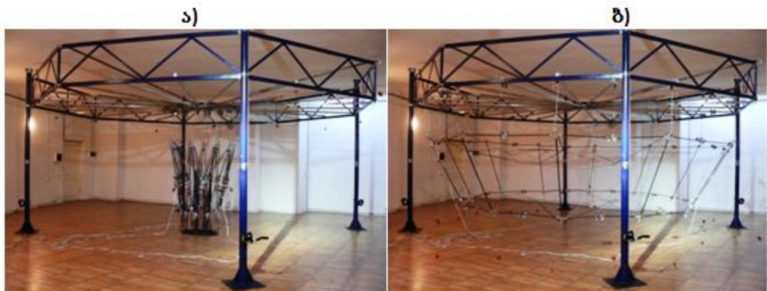
ნახ.39 - წაკვეთილი პირამიდის ფორმის მქონე „ჩასატეხ ღეროებიანი“ , ზამზარებით გასახსნელი რგოლიანი და მოქნილი, გაჭიმულ ცენტრიანი გასაშლელი კოსმოსური რეფლექტორის გაშლის ფოტოციკლოგრამა
