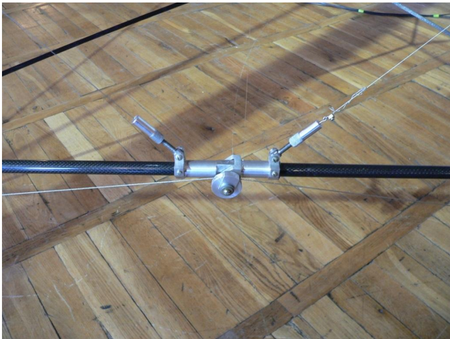
fig. IV.4 _ qveda sartyelis mosazRvre berketebis gamaerTianeбели kvanZis foto gaSlili rgolis SemTxvevaSi.
