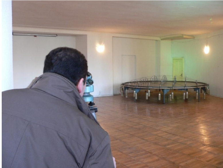
fig. III. 26 _ stapelis preciziul zedapirze gadaWimuli, moqnili, samkuTxa formis mqone badis kvanZebis sivrceSi ganTavsebis koordinatebis Semowmeba zusti optikuri xelsawyoTi
