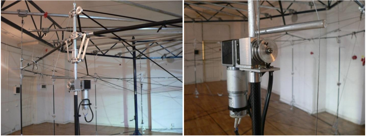
fig. IV.9 _ dgarze ganTavsebuli eleqtroamZravis mbrunav dolze ganTavsebul or dolze rgolis gamSleli Zalovani bagiris daxveva
