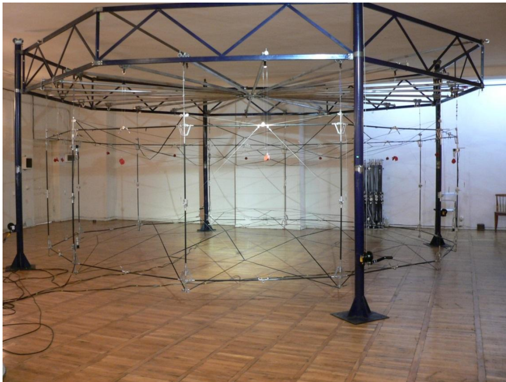
fig. IV.13 _ gamSleli Zalovani rgolis mier reflektoris moqnili centris xarisxiani daWimvis foto.
