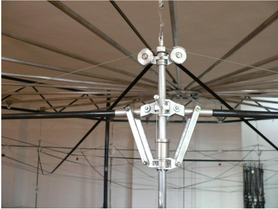
fig. IV.5 _ gamSleli rgolis zeda sartyelis dgarTan mierTebis, gamSleli Zalovani bagiris kvanZze gadatarebis, sartyelis berketebis gaSla_dakecvissinqronizaciis da rgolze refleqtoris moqnili centris mierTebis kvanZis foto, romelzec aseve naCvenebia dgaris vanturi Sprengelis mowyobis zeda kvanZi.
