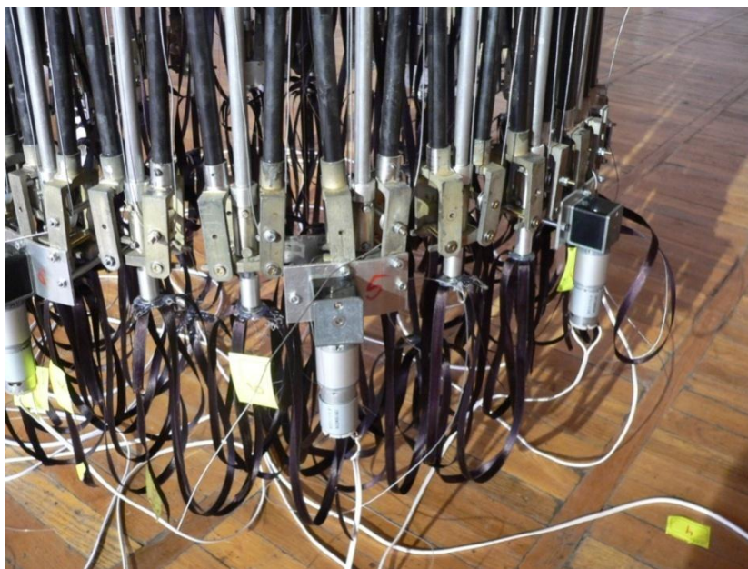
fig. III.14 _ gasaSlelioTximetridiametrismqone, 24-seqcianreflektorzeg ganTavsebulirvaeleqtroamZravisfragmentisfoto.
