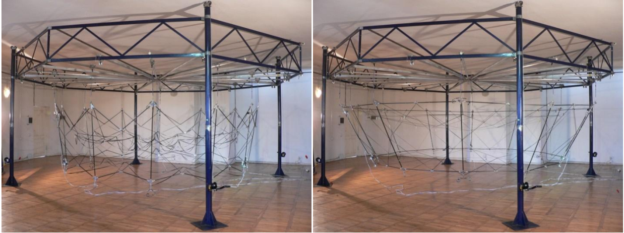
fig. Y 3.49 _ wakveTili piramidis formis mqone, „Casatex“ Reroebiani, eleqtromeqanikuri sistemiT gaSladi, moqnili, gaWimul centriani refleqtoris gaSlis etapebis fotokadrebi
