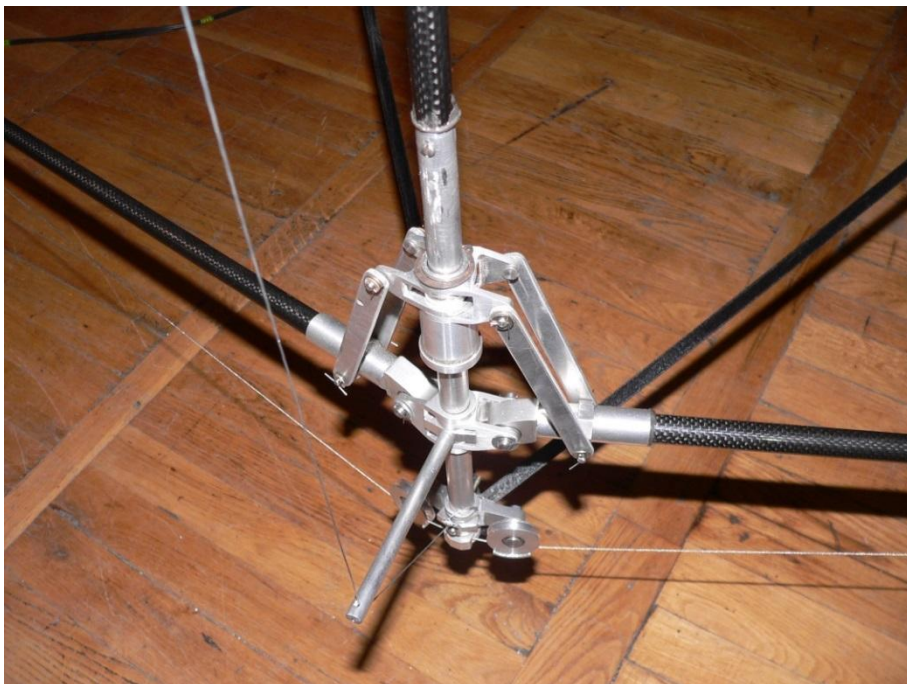
fig. IV.6 _ gamSleli rgolis zeda sartyelis dgarTan mierTebis, gamSleli Zalovani bagiris kvanZze gadatarebis, sartyelis berketebis gaSla_dakecvissinqronizaciis da rgolze refleqtoris moqnili centris mierTebis kvanZis foto, romelzec aseve naCvenebia dgaris vanturi Sprengelis mowyobis qveda kvanZi.
