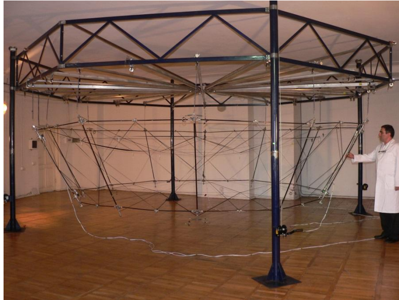
fig. III.50 _ rgolis geometriuli ucvelobis uzrunvelyofis bagirovani, rombis formis sistemiT, arsebuli stabilizaciis sistemis Secvlis Semdeg, funqionaluri modelis saerTo sixistem da rxevis sixSiremac moimata. es efeqti aseve realurad igrZnoboda misi sivrceSi xeliT orientaciis dros.
