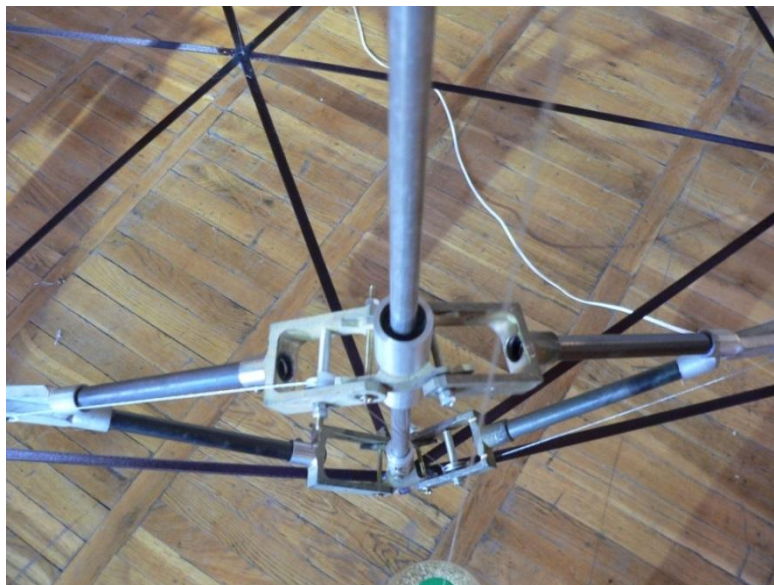
fig. III.16_ mosazRvre pantografis berketis cilindruli saxsrebiT SemaerTebeli kvanZis moZraoba dgaris gaswvriv xorcieldeba kvanZSi ganTavsebuli grZivi sakisriT, romelic Camocmulia dgarze.
