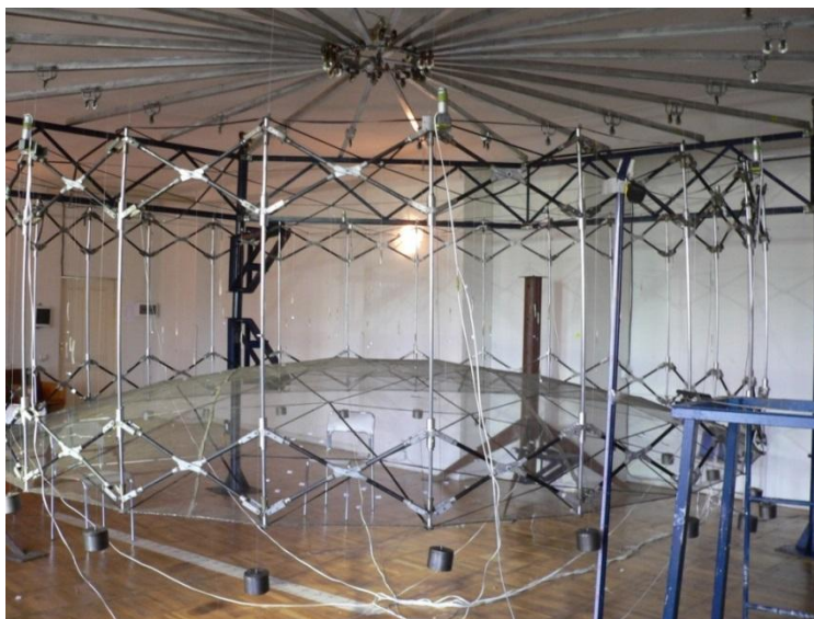
fig. III.24 _gravitaciuli efeqtis gamoricxvisaTvis, xist sayrdenebSi dgaris saSualebiT konsolurad Camagrebuli refleqtori, aseve gamoicada gadmobrunebul mdgomareobaSi, rodesac amrekli badis mxare ukve qvemoT ganTavsda.
