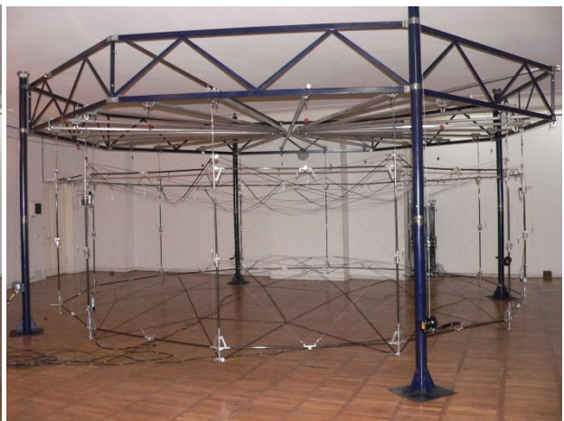
fig. IV.16 _ vantur_Rerovani gasaSllel rgoliani, moqnili daWimul centriani gasaSleli kosmosuri refleqtoris eqsperimentuli variantis gaSlis 12-kadriani foto-ciklograma.
