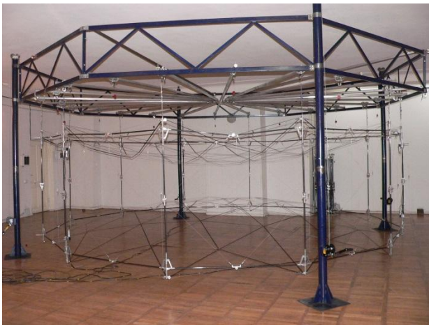
fig. IV.16 _ vantur_Rerovani gasaSllel rgoliani, moqnili daWimul centriani gasaSleli kosmosuri refleqtoris eqsperimentuli variantis gaSlis 12-kadriani foto-ciklograma.
