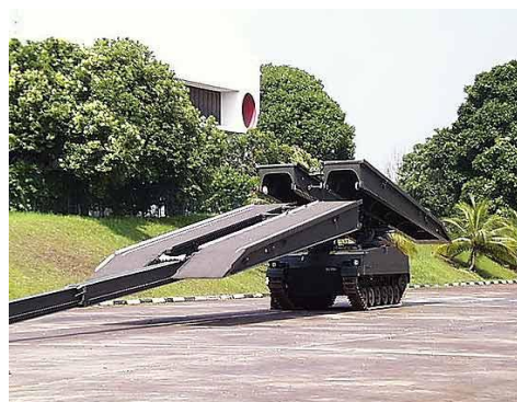
fig. I.7 – a) xidgamdebi, romelic xids gadasalax winaaRmdegobaze debs “wamocmis” meTodiT satransporto mdgomareobaSi; b) xidgamdebi, teleskopis isris gamoyenebiT amontaJebis “teleskopis principi” transformirebad xids.
