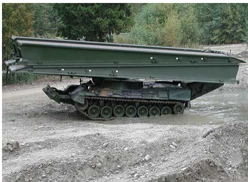
fig. I.7 – a) xidgamdebi, romelic xids gadasalax winaaRmdegobaze debs “wamocmis” meTodiT satransporto mdgomareobaSi; b) xidgamdebi, teleskopis isris gamoyenebiT amontaJebis “teleskopis principi” transformirebad xids.
