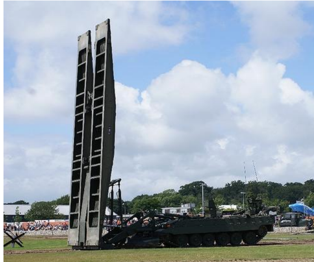
fig. I. 17 – “Titan”-is klasis erTmaliani da erTblokiani xidis montaJi, xidgamdebidan misi ”gadabrunebiT”.
