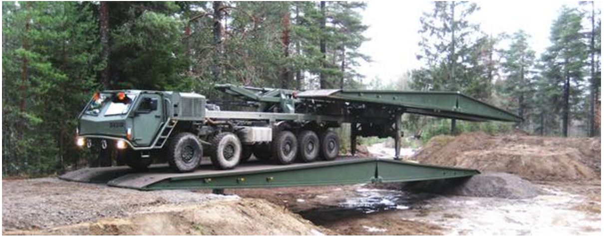
fig. I.14 – LEGUAN-1-is sistemis xidis gaSlis procesi.
