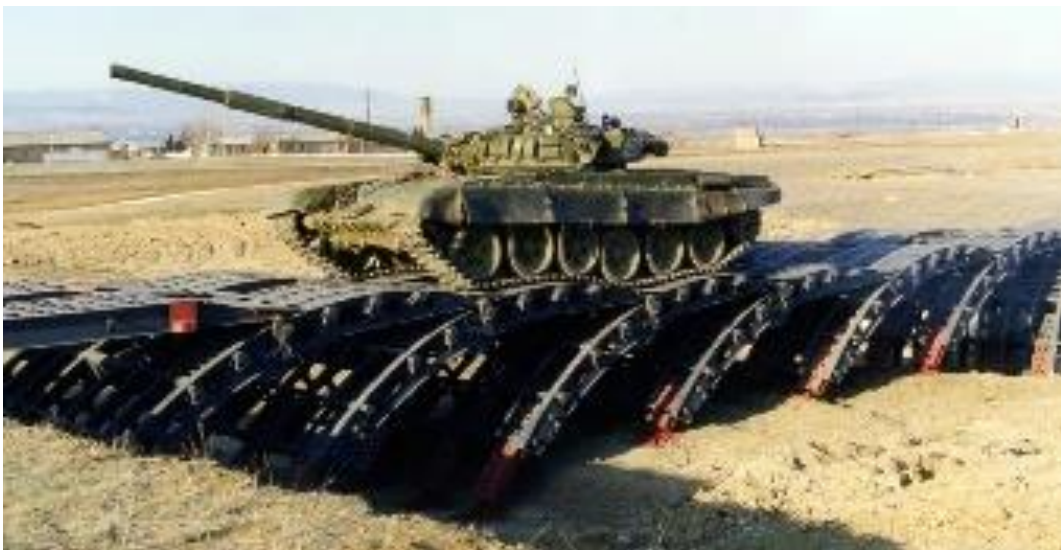
ფიგ. III. 13. ასაწყობი ხიდი (დამზადებულია სქართველოს ტექნიკური უნივერსიტეტის ნაგებობების, სპეციალური სისტემებისა და საინჟინრო უზრუნველყოფის ინსტიტუტში)
