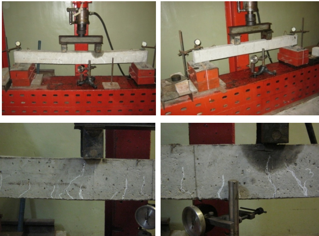
ნახ. 45 რკინაბეტონის კოჭების პირველი სერიის გამოცდა
