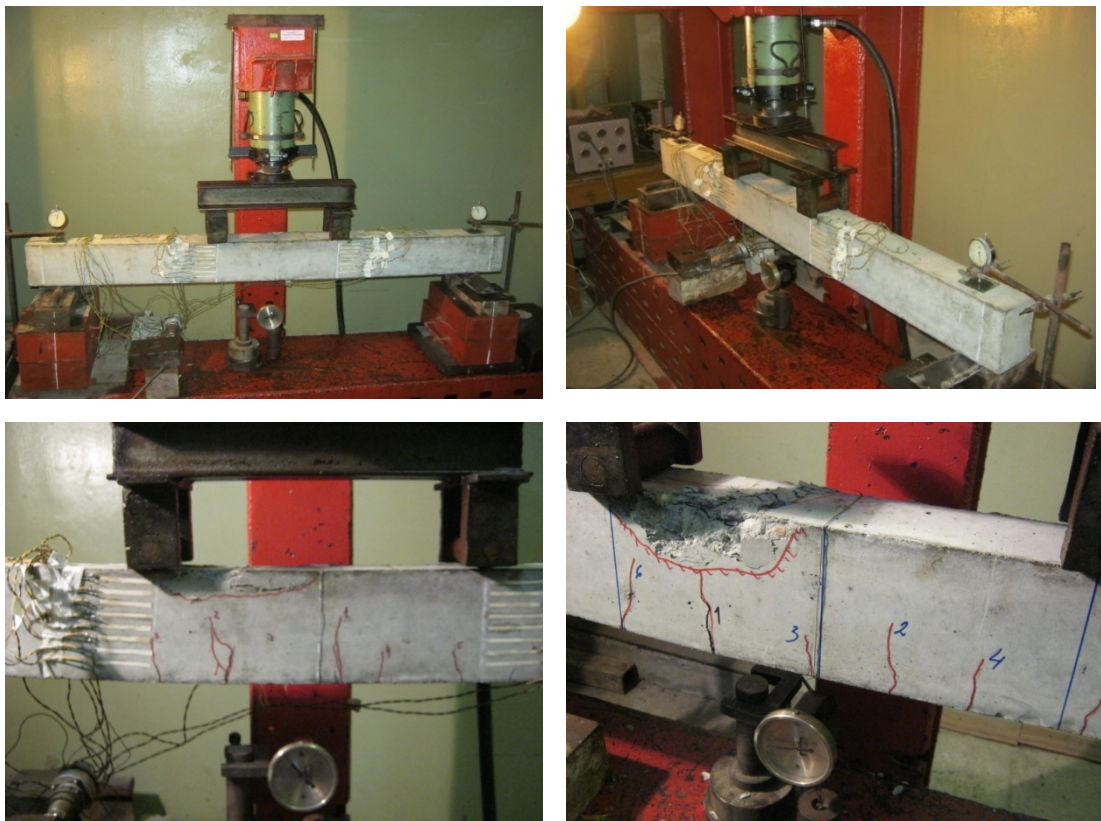
ნახ. 46 რკინაბეტონის კოჭების II სერიის გამოცდა
