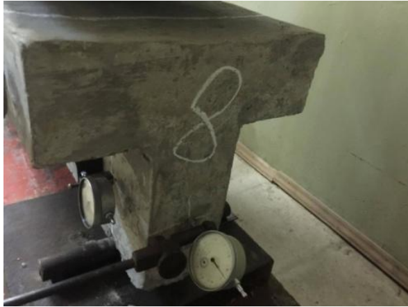
ნახ.28. რკინაბეტონის შედგენილი კვეთის კოჭი
