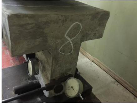
ნახ.17. რკინაბეტონის შედგენილი კვეთის კოჭი
