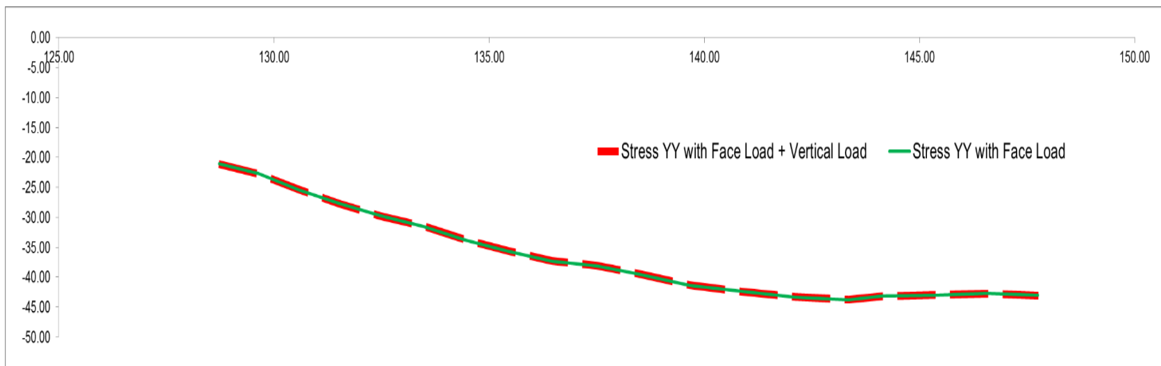
ნახ. 4.29: \sigma_y Zabvebi 4-4 kveTSi (7001 – 7003). wiTeli da wyvetili texili xazi - \sigma_y Zabvebi meore SemTxvevisaTvis – yvela Zalis erToblivi moqmedeba; mwvane texili xazi - \sigma_y Zabvebi pirveli SemTxvevisaTvis – mxolod sakuTari wona hidrostatikuri dawneva sadawneo waxnagze.
