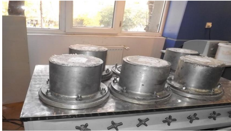
სურათი №4.1 ჰიდროტექნიკური ბეტონის ცილინდრული ნიმუშები წყალშეუღწევადობის სტენდზე
