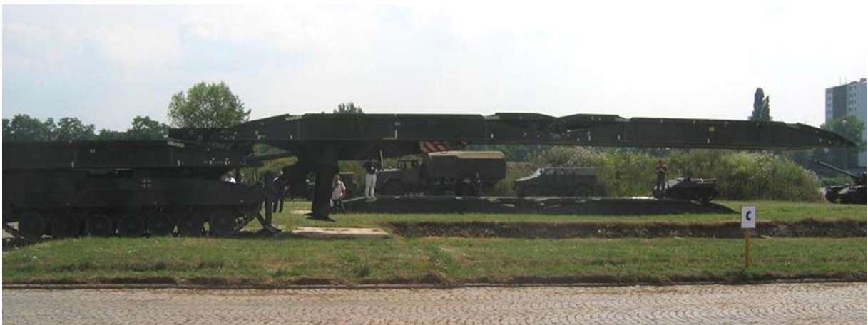
ფიგ. I. 10 – ხიდგამდების “Panzerschnellbrücke PBS-2”-ის კონსოლურ საყრდენზე, გადასალახი დაბრკოლების თავზე გრძივად განთავსებულია სამი 9-მეტრიანი სიგრძის ურთუერთდაკავშირებული ბლოკები, რომლებიც შეადგენს 27 მ სიგრძის საიერიშო ხიდს.
