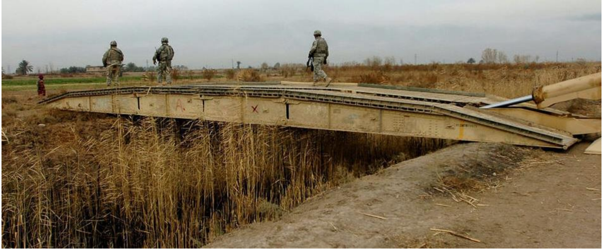
ფიგ. IV.6 – ხიდგამდები “M60 AVLB”-ის მიერ გადაებული გასაშლელი ხიდი გაშლილ – საექსპლოატაციო მდგომარეობაში.
