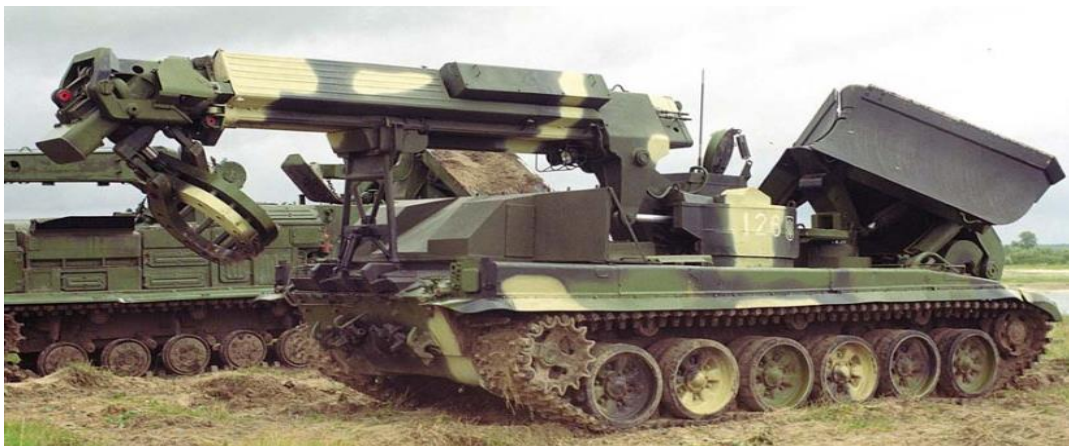
ფიგ. IV.32 – ტყის მჩეხავი რუსული დაჯავშნული სატრანსპორტო საშუალება “IMP-2”
