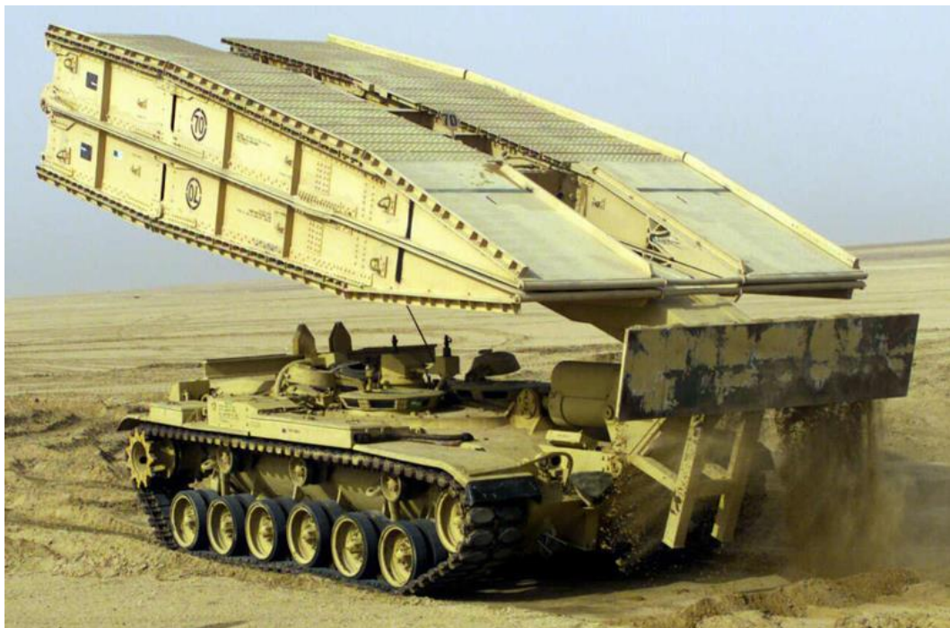
ფიგ. IV. 3 – ხიდის სატრანსპორტო პაკეტის წამოწევის პროცესი ხიდგამდგებ “M60 AVLB”-ზე.
