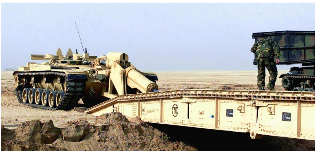
ფიგ. IV. 5 – ხიდგამდები “M60 AVLB” ამთავრებს ხიდის გაშლას, რასაც იგი უზრუნველყოფს მძლავრი გადმოსაშლელი ჰიდრაულიკური სისტემების მქონე მექანიკური – კონსტრუქციული სისტემით.
