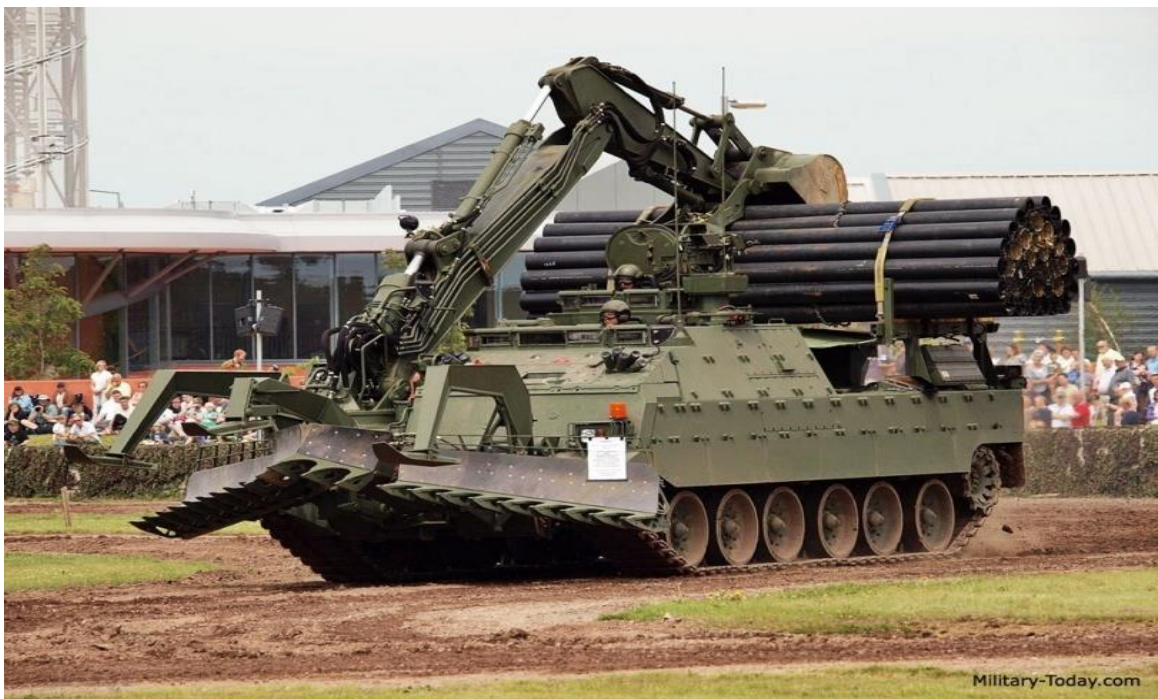
ფიგ. IV. 29 – გამნადმავი, დაჯავშნული სატრანსპორტო საშუალება – “TROJAN”.
