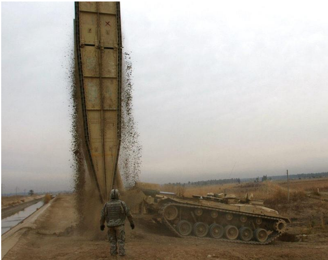
ფიგ. IV. 7 – ტანკ “M60”-ის ბაზაზე აკეცილი ხიდი განთავსდება ზედაპირის ძლიერი დაბინძურების პირობებში.
