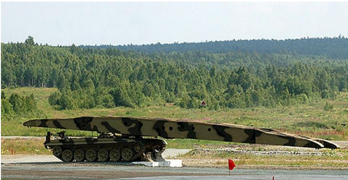
ფიგ. I. 16 – ხიდგამდებ “MTU-72”-ს ტანკ “T-72”-ის ბაზაზე განთავსებული სამაგრიტ კონსოლურად უჭირავს გახსნილი ხიდი, რომელიც განაგრძობს ტანკიდან გამოწვევას და შემდგომ გაიდება დაბრკოლებაზე.
