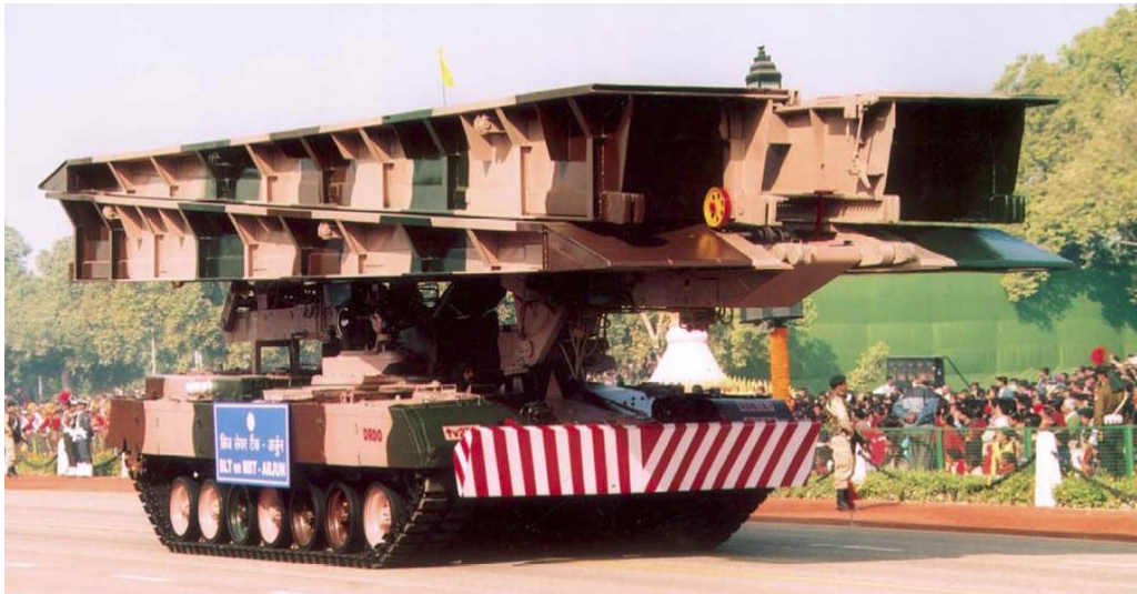
ფიგ. I. 11 – ხიდგამდები “Arjun BLT” სატრანსპორტო მდგომარეობაში.
