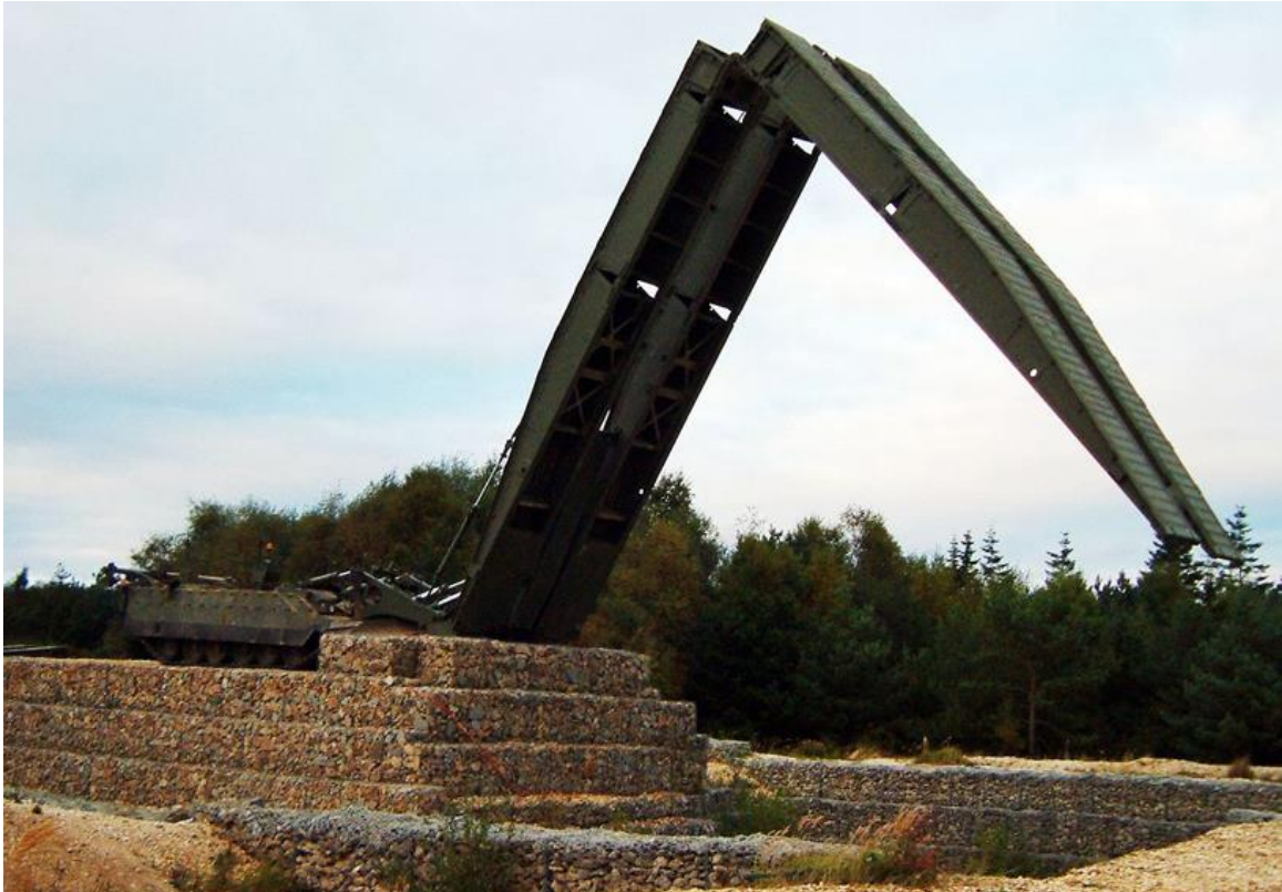
ფიგ. IV. 9 – ხიდგამდებ “Titan”-ის მიერ ხიდის გაშლის სქემაში გამოყენებული დამატებითი მჭიმები.
