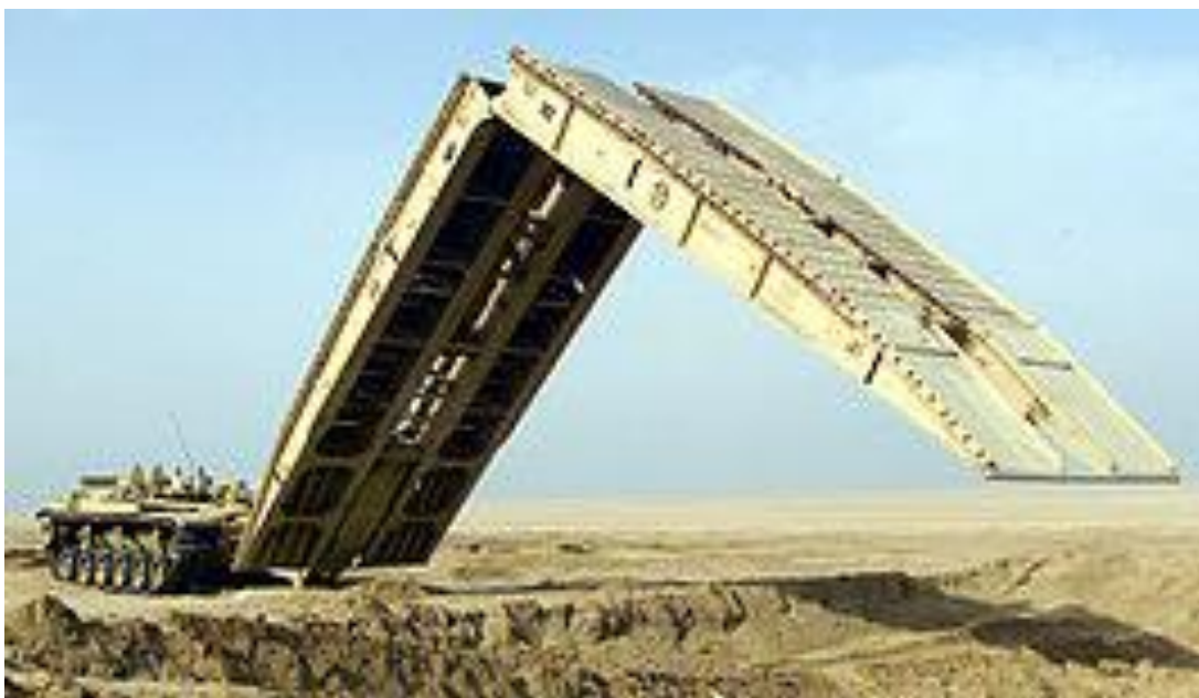
ფიგ. IV. 10 – გასაშლელი “მაკრატლის” ტიპის საიერიშო ხიდი განთავსებული ხიდგამდები “M60 AVLB”-ზე
