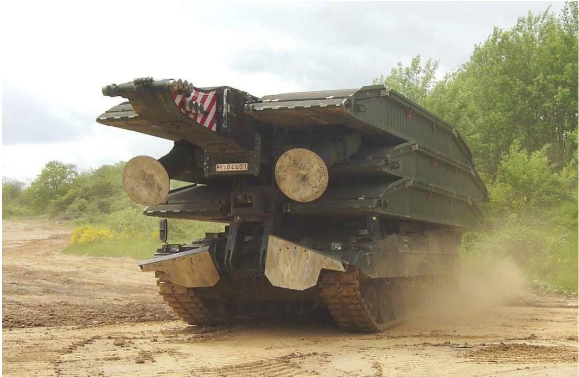
ფიგ. I. 9 – ხიდგამდების – “Panzerschnellbrücke PBS-2” ხედი სატრანსპორტო მდგომარეობაში, როდესაც ტანკ “Leopard 2 MBT”-ზე განთავსებულია ხიდის სამი ბლოკი, თითოეული 9 მ სიგრძის.
