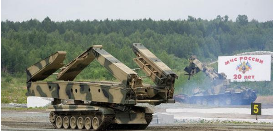
ფიგ. I. 15 – ხიდგამდებ “MTU-72”-ზე განთავსებული 20 მეტრის, სამი ბლოკისგან შედგენილი ხიდი იწყებს თავისი ორი ბლოკის გაშლას
