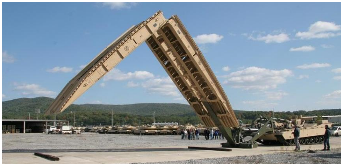
ფიგ. IV. 11 – ხიდგამდები “JAB AVLB”, აგებული ტანკ “A1M1”-ის ბაზაზე სადემონსტრაციო მოედანზე
