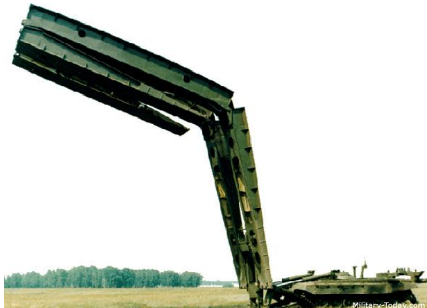
ფიგ. I. 14 – “ორმაგი მაკრატლის” სქემით ურთიერთდაკავშირებული ხიდის სამი ბლოკი, განთავსებული ტანკ “T-90”-ზე.
