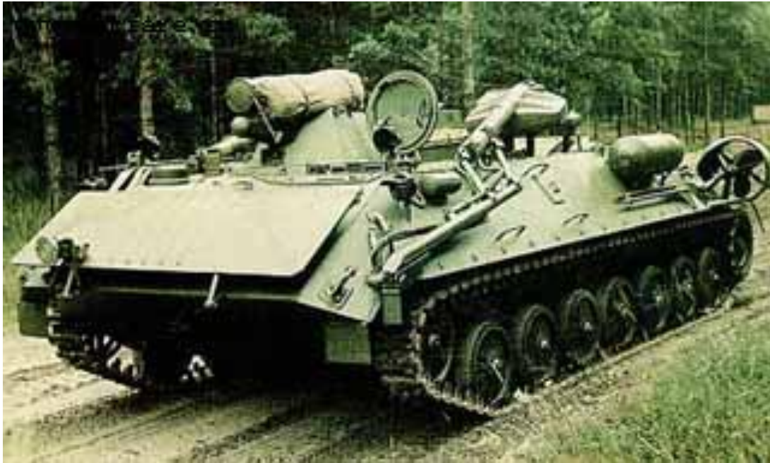
ფიგ. II. 4 – რუსული წარმოების, დაჯავშნული საინჟინრო სადაზვერვო მანქანა IPRM
