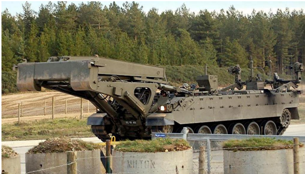
ფიგ. IV. 8 – ხიდგამდები “Titan”-ის გასაშლელი ხიდის გადმოშლელი სივრცითი მექანიზმი განთავსებული ტანკ “Challenger 2”-ზე
