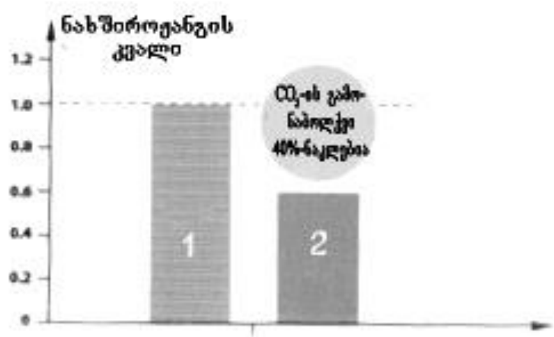
ნახ. 3. 4 თბოგადამცემების გარემოზე ზემოქმედების გრაფიკები. 1 - მირჩილული თბოგადამცემები 2- მიკროარხული თბოგადამცემები.
