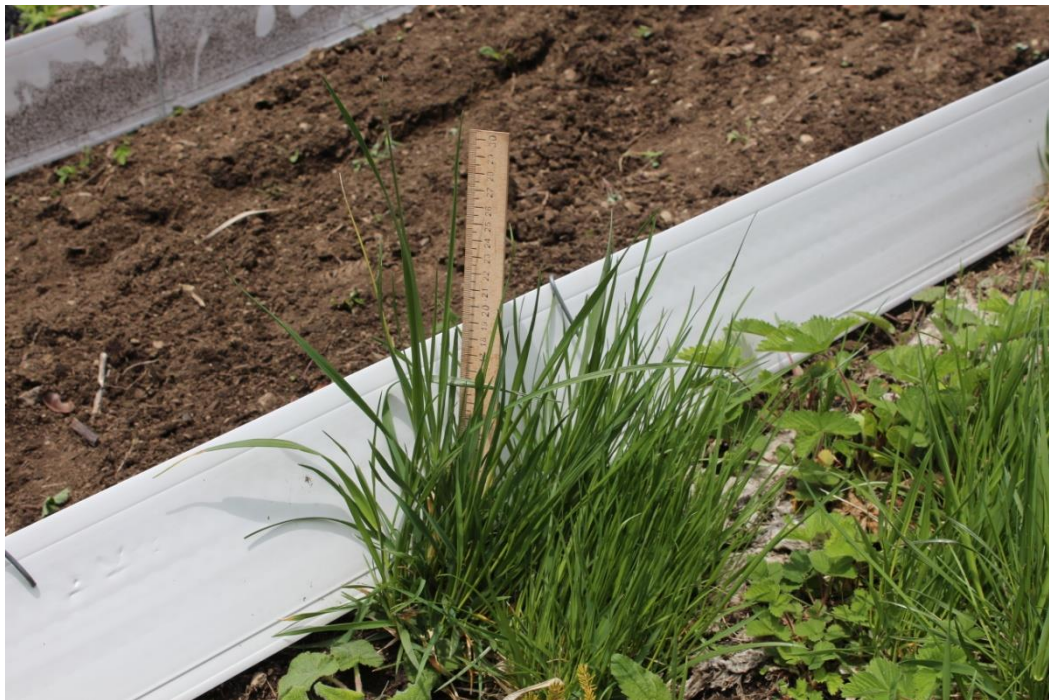
ფოტო 3.2.9 გეოხალიჩა ნესგეოზე ამოსული მცენარეების ზრდის დინამიკის დადგენის პროცესი
