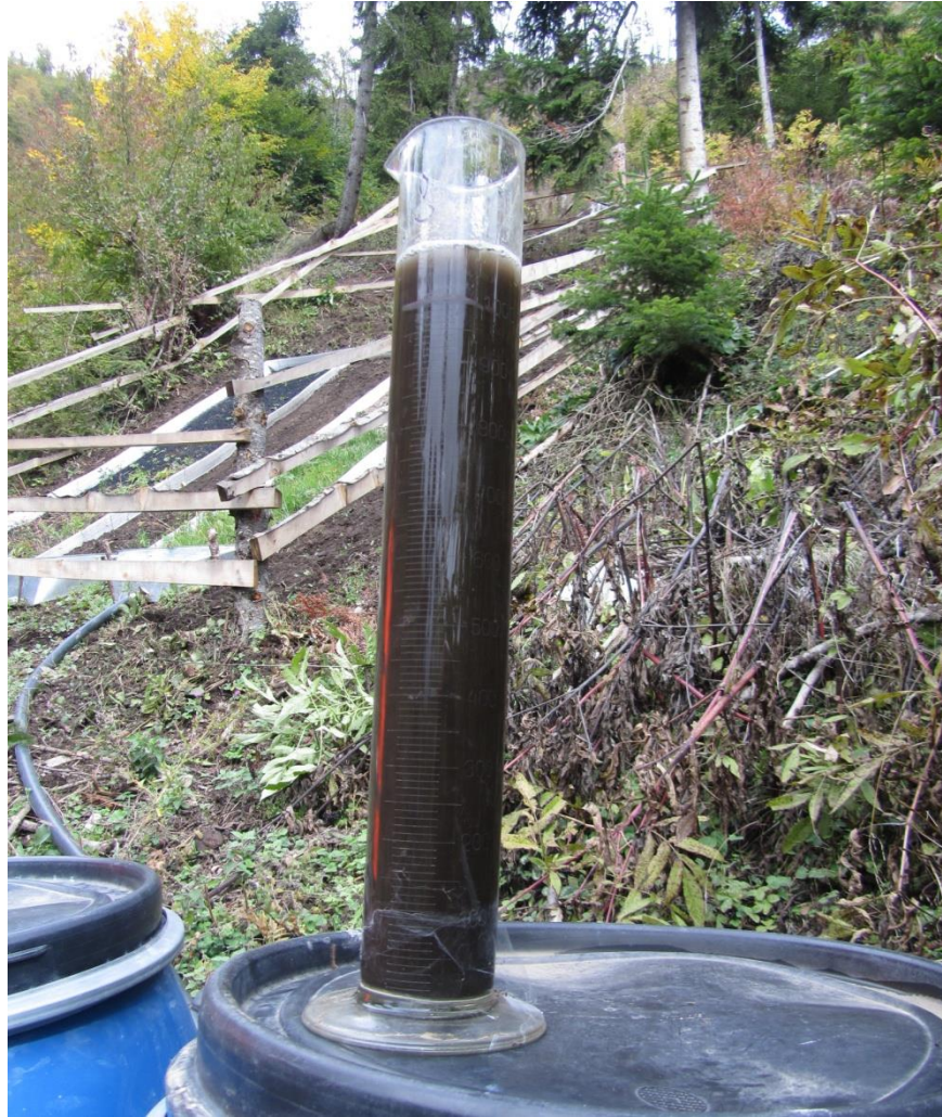
ფოტო 3.2.8 ნატანმიმღები რეზერვუარიდან აღებულ სინჯში მიმდინარე მყარი ჩამონადენის დალექვის პროცესი
