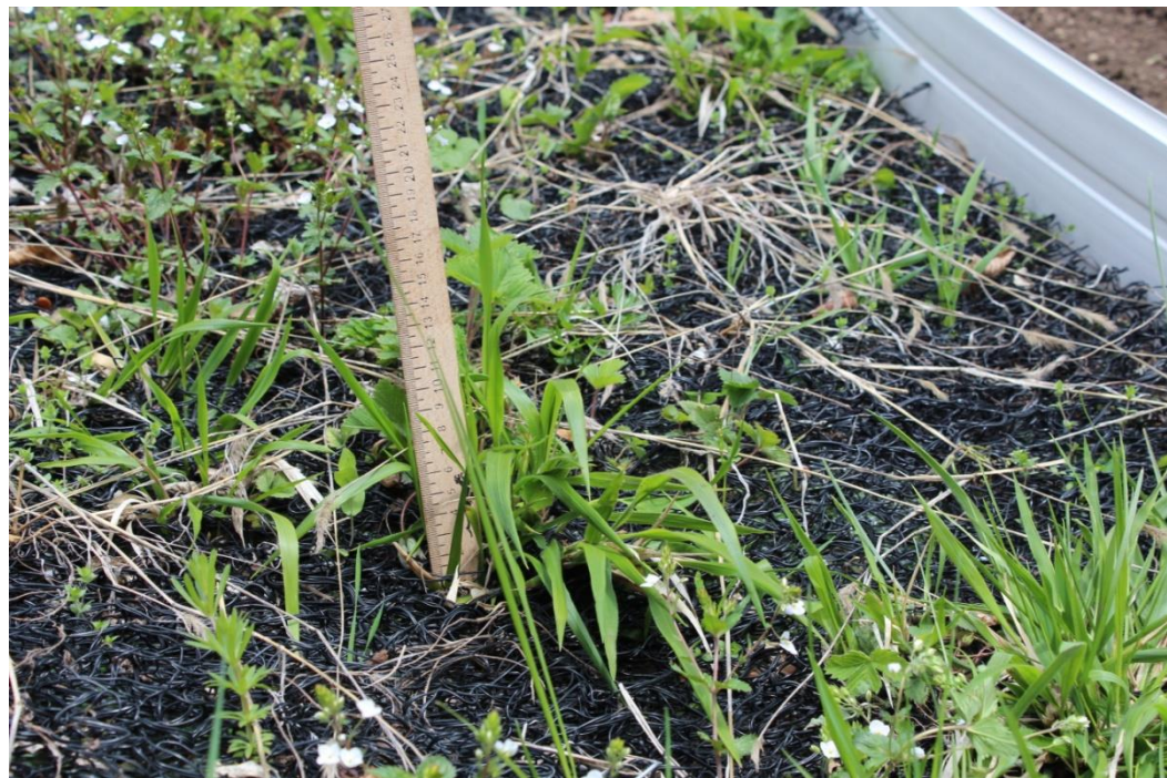
ფოტო 3.2.11 გეობალიჩა სეკუმატზე ამოსული მცენარეების ზრდის დინამიკის დადგენის პროცესი
