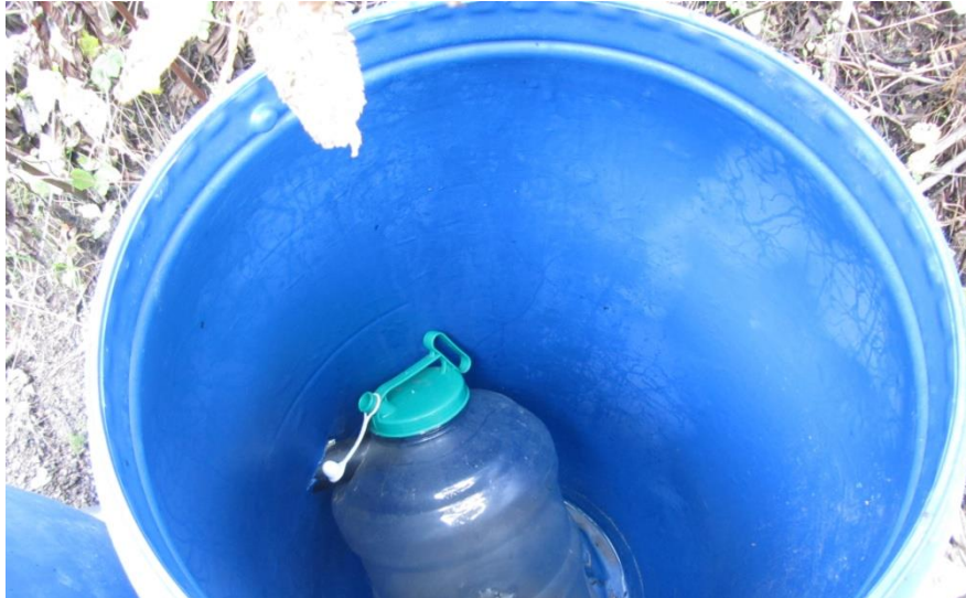
ფოტო 3.2.6 საველე პოლიგონის ქვევით განთავსებულ დიდ რეზერვუარებში მოთავსებული მცირე მოცულობის ნატანმიმღები კასრები
