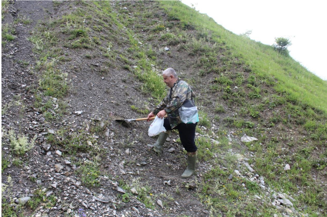
ფოტო 2.2.1. მლეთის ხევში არსებული ეროზირებული ფერდობიდან ნიადაგ-გრუნტის ნიმუშის აღება
