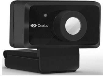
ნახ.5.19. Oculus Rift DK2 პოზიციის განმსაზღვრელი მოწყობილობა (OCULUS VR, LLC, 2015)
