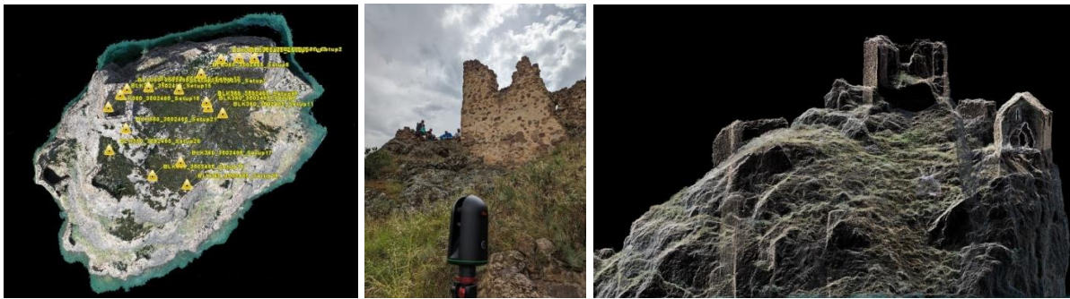
სურ.3. 3D ლაზერული სკანერით გადაღების შედეგად მიღებული რეგისტრირებული წერტილთა ღრუბელი
